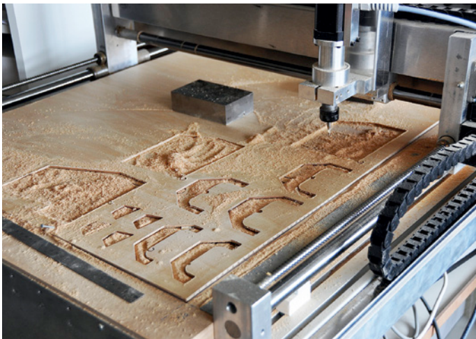
CNC-STEP High-Z S-1000 fräst die Rumpfspanten aus. La CNC-STEP High-Z S-1000 fraise les couples du fuselage.
