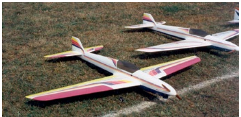
Matador mit grosser Flügelstreckung, von Peter Erang, Deutschland, in Holz-Styropor-Bauweise. La Matador à grand allongement de l'Allemand Peter Erang en construction bois-styropor.
