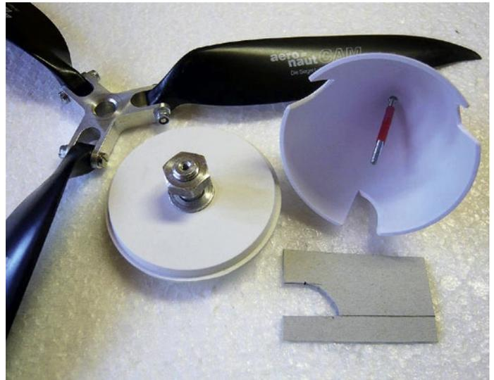
**Bild 5: Die fertigen Spinner-Teile (Grundplatte + Kappe mit Schraube) wiegen nur 18 g. Werden die in der Beschreibung fett gedruckten Masse eingehalten, erreicht man übrigens exakt die gewünschte totale Spinnerlänge.**
