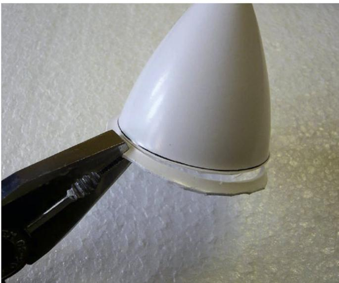
Bild 3b: Leichtes Trennen bei der Kerbe.
