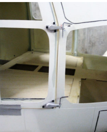
Die sehr detaillierte Pilotentür im Rohbau, sehr Scale die Alu-Türscharniere.
