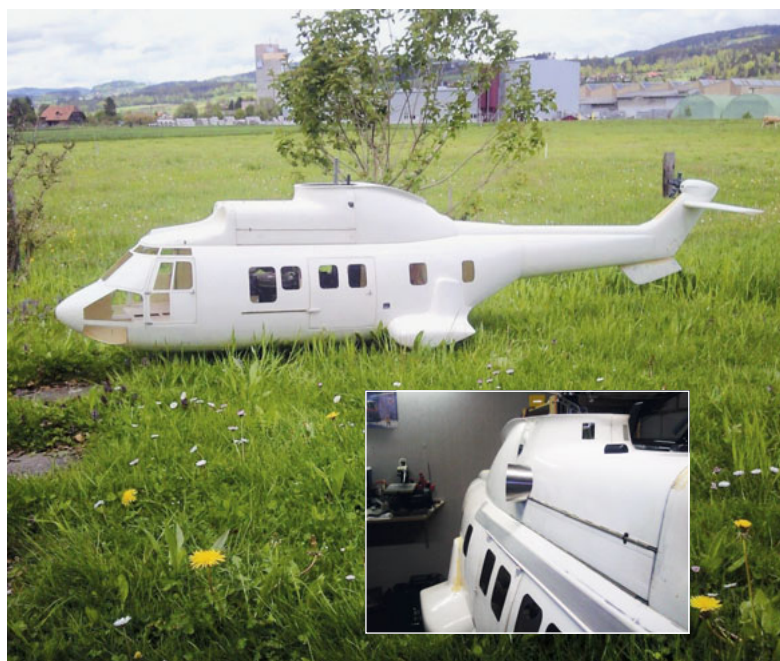
Der Rohbau ist abgeschlossen, die Mechanik probeweise eingebaut, sowie auch der Heckrotor.
