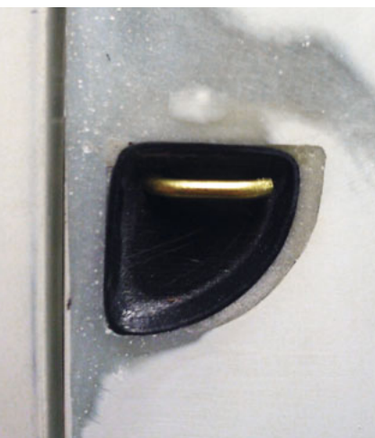
Verriegelung der Turbinenverschalung. Hier wurde ein ABS-Tiefziehteil angefertigt und eingeklebt. Als Klinke wurde ein Messingdraht zu rechtgebogen.
