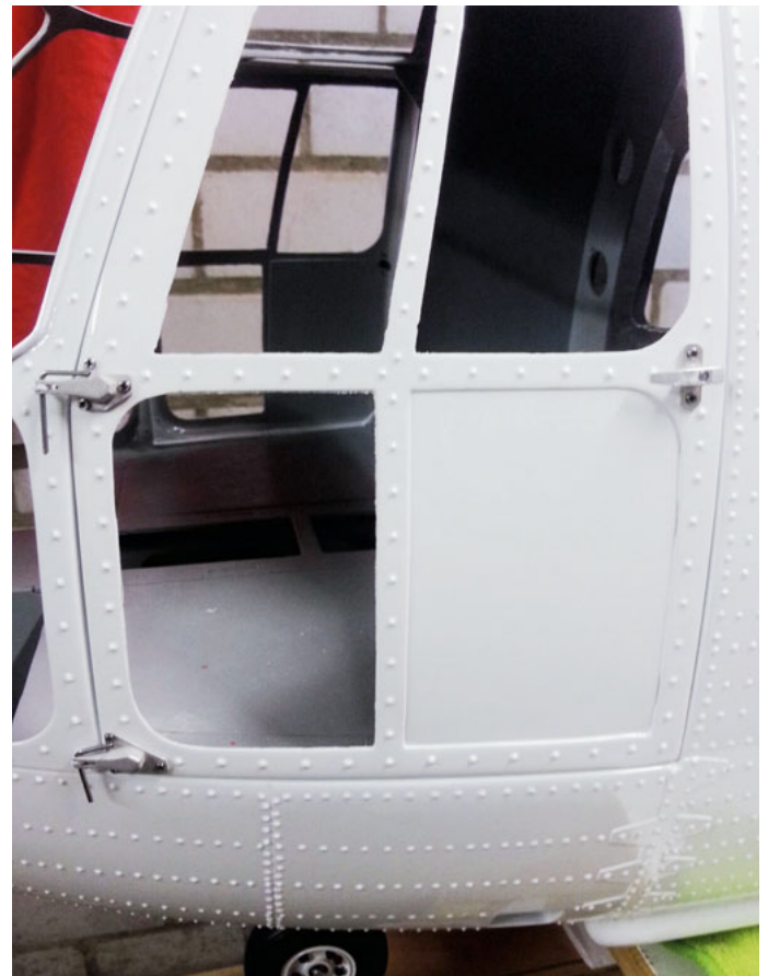
Der Rumpf ist fertig lackiert. Sehr schön kommen die Nieten sowie die Imitationen für die Verstärkungen zur Geltung.
