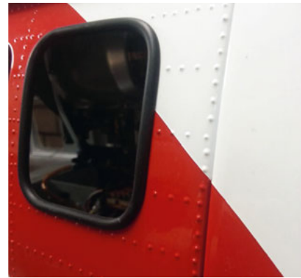
Die Scheiben wurden mit grossem Aufwand in die Fenstergummis eingesetzt.
