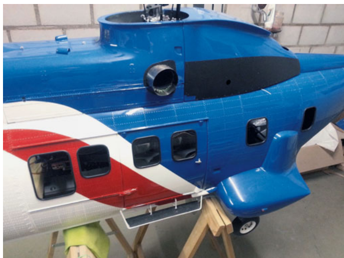
Der Rumpf ist fertig lackiert. Sehr schön kommen die Nieten sowie die Imitationen für die Verstärkungen zur Geltung.
