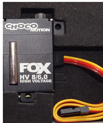
Leistungsservos tragen gerne «bauchfrei»; zwecks besserer Kühlung. Natürlich kann die leicht hervorstehende Bauchrundung einer wirklich schlanken Figur nichts anhaben.
