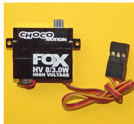
Kompaktes HV-Servo. Die Aufschrift verrät noch nicht den Arbeitsspannungsbereich!
