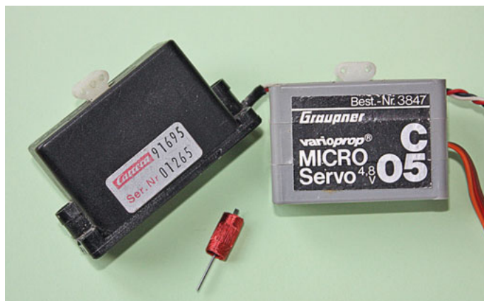
Früher waren auch Servos mit Linearantrieb auf dem Markt.
