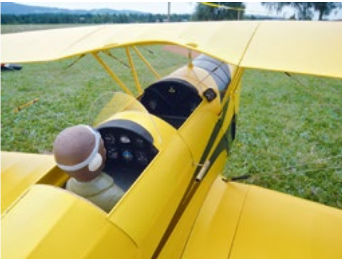
Einfaches Cockpit, Tankanzeige und Drehzahlmesser.
