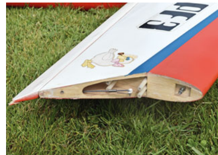
Die Querruderservos sassen im Randbogen auf Stelzen.
