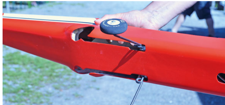
Hier wird deutlich, wie das Fahrwerk nach hinten in den Rumpf einfährt.
