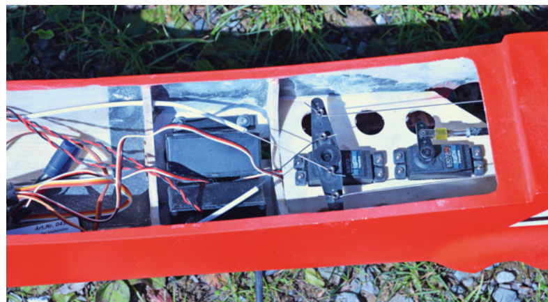
So sitzt das elektrische Giezendanner-Fahrwerk im neuen, verbreiterten Sandwich-Rumpf.
