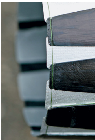
Drahtzug zur Öffnung des Auslasses.
