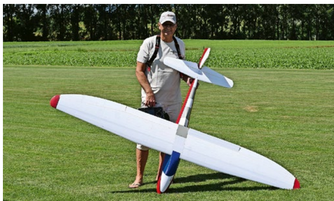
Le LO 100 nécessite plus de 200 heures d'impression et 3,5 kg de filament. Sa charge alaire dépasse 60 g/m². Trouvé sur le site Cults 3D, 3D-printed gliders.
