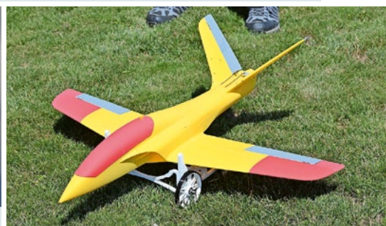
Le Cobra d'Eclipsion avec une turbine de 50 mm, dépourvu de longeron en carbone, il reste fragile. Le chariot est également imprimé 3D.
