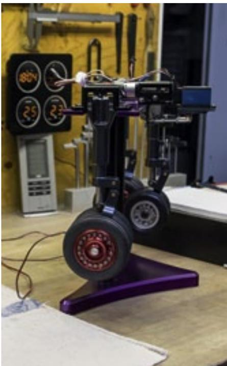
Sämtliche Einzelteile für den Fahrwerkprüfstand und das bereits montierte Fahrwerk sind auf dem Bearbeitungszentrum entstanden. Nur das Eloxieren erfolgte auswärts.
