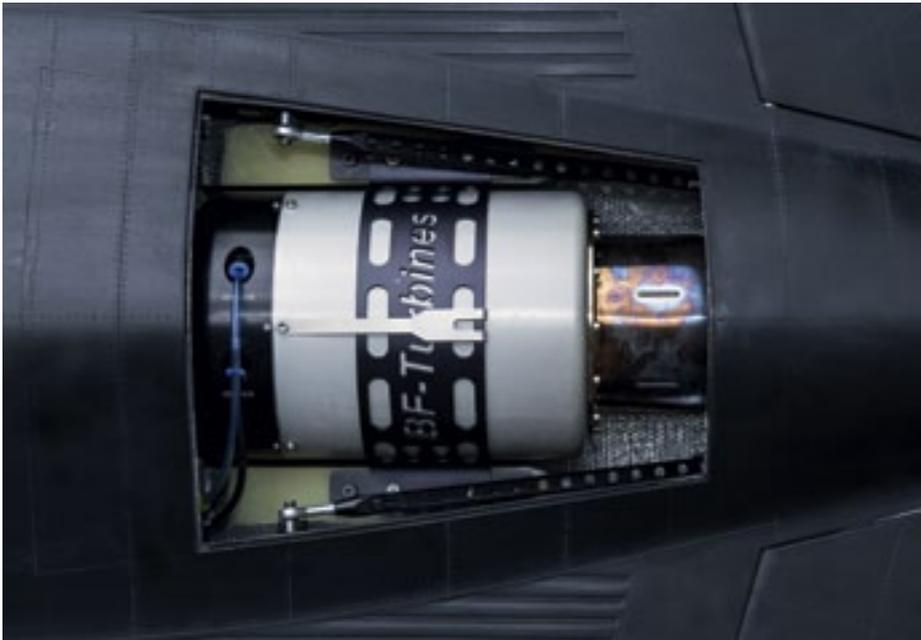
Eine grosse schwarze SR-71 mit einer erneut im Rumpf versteckten Turbine. Hier wirkt das auf einer flachen Platte in der Triebwerksgondel montierte Foto als raffiniert abgebildeter Triebwerksauslass noch viel echter.
