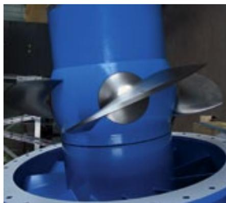
Schaufeln einer Kaplan turbine. Auf dem gleichen Bearbeitungszentrum wie die SR-71-Teile wurden auch diese Metallstücke jeweils aus einem vollen Block gefräst. (Bild Bunorm AG)
