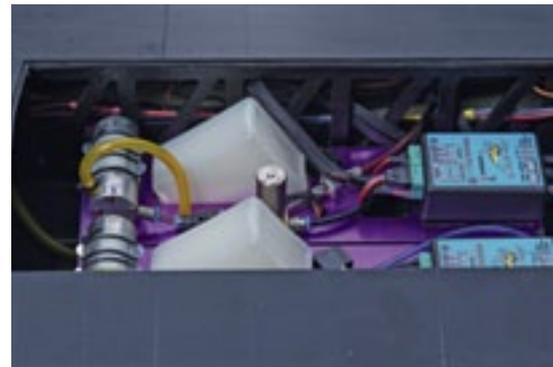
**Im zweistrahligen Blackbird gibt es tatsächlich in jeder Triebwerksgondel eine Turbine. Dass nun definitiv keine Täuschung vorliegt, beweisen die Schubrohre in den Gondeln und die beiden elektronischen Triebwerkscontroller.**
