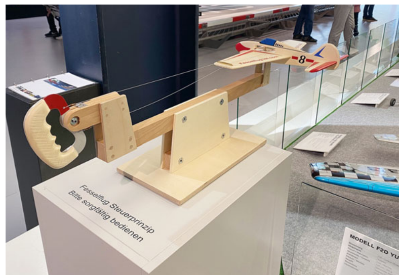
Funktionsmodell des Fesselflug-Steuerprinzips.
