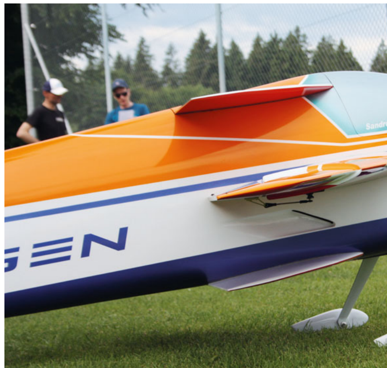
Recherche de symétrie: aile médiane et petites ailettes symétriques de part et d'autre.
