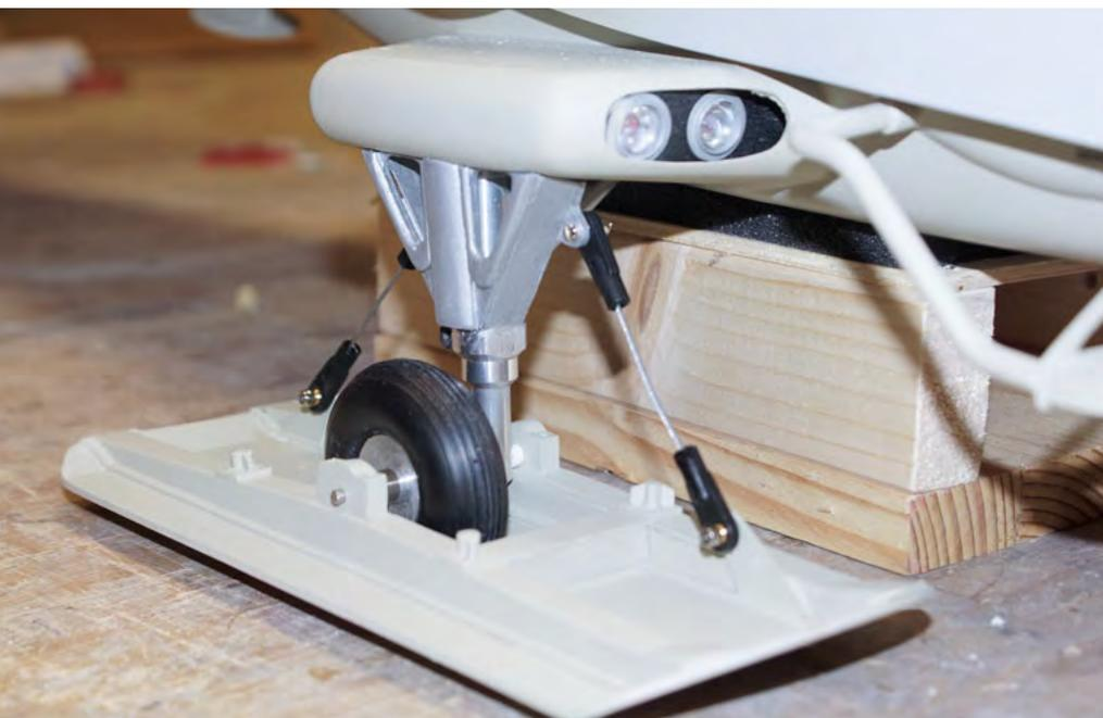
Landescheinwerfer im Stummelflügel (oben), Hauptfahrwerk mit montierten Skiern. Feux d'atterrissage dans le support de train (ci-dessus), train d'atterrissage principal avec skis montés.
