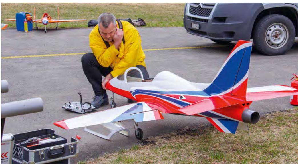
Prova della spinta della turbina.
