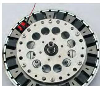
**Profis am Werk: Multipolmotor für einen Heli-Direktantrieb.**
