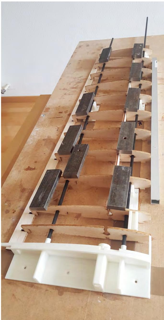
Peigne de positionnement des nervures visible au bord de fuite.
