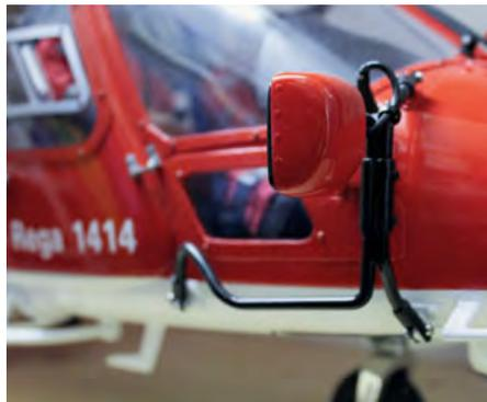
**Bereits mit dem neuen Unterlastspiegel für den Piloten.**
