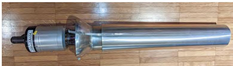
Turbina con tubo di spinta.
