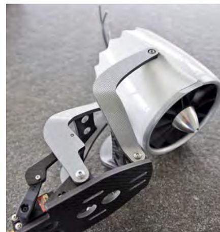
**Mit dem einziehbaren Elektro-Impeller geht's zügig durch die Luft. Eine lahme Ente beim Starten.**
