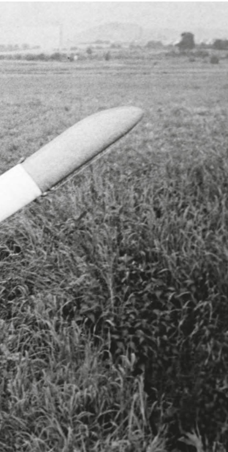
Flügel seiner Modelle sind im ersten Drittel sowohl auf der Oberseite als auch auf der unteren Seite beplankt. Dadurch entsteht ein geschlossenes Rohr: Oberseite – Nasenholm – Unterseite – Holmsteg (heute D-box genannt). Für die damalige Zeit ein Novum. Diese Bauart verstärkt die Torsionsfestigkeit enorm und die Flügel lassen sich kaum verdrehen. Eine geniale spaltenfreie Flügelbefestigung mit einer Schraubenfederbefestigung ist ein weiteres wirksames Ergebnis stetiger Optimierung.
