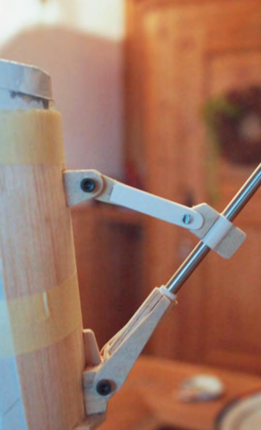
**Der aufwendig nachgebaute Hecksporn.
