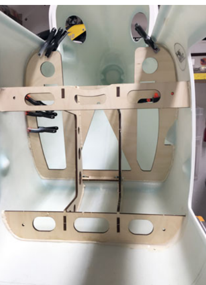
Rinforzo della fusoliera tramite centine.
