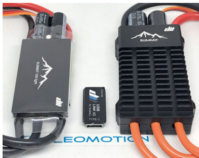
Summit 100LV light (links), USB Link V2 (Mitte) und Summit 120 HV (rechts) verfügen über Rekuperation.
