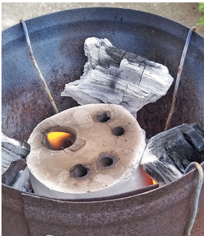
Ausbrennen des PLA-Materials.
