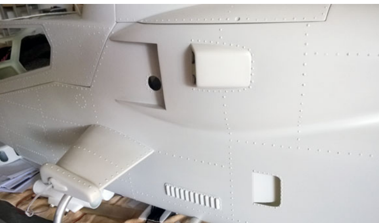
Alles fertig benietet und die Grundierung ist aufgebracht.
