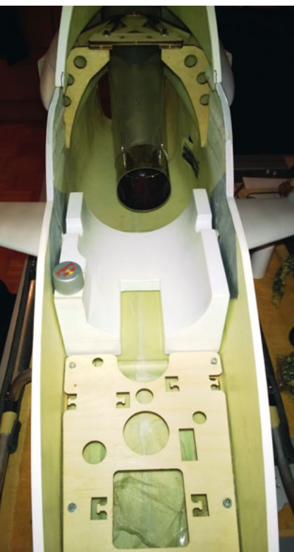
Der neue Spantensatz ist eingebaut. Tank und Abgasrohr werden eingepasst.
