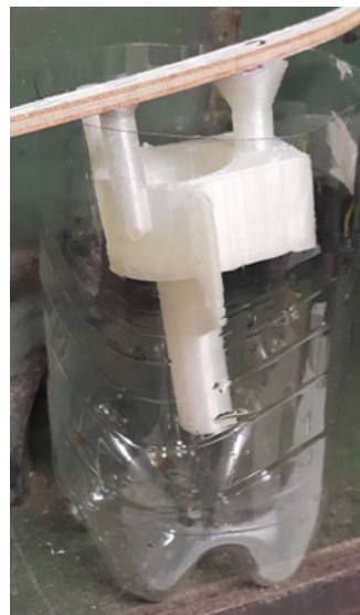
3D-Druck fertig zum Einformen mit Gips.
