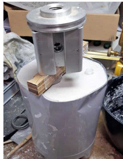
Beschwerung, damit die Form nicht aufschwimmt.
