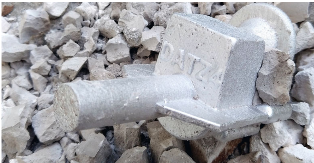
Erster brauchbarer Guss des Kurbelgehäuses.
