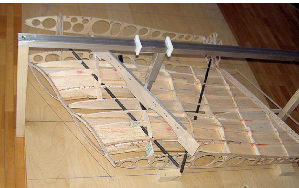
Aufbau Flügel kombiniert.
