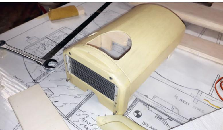
Motorhaube mit Kühlerattrappe, bereits mit Oratex,Folie «Antik» überzogen.
