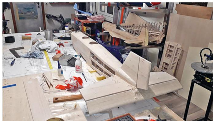
Die Kanzeln sind bereits ausgeschnitten, die Spuren vom Verschleifen sind deutlich zu sehen.
