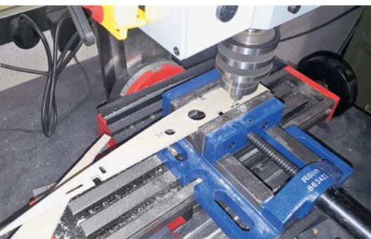
Die Schraubbefestigungsschlitz der Hauptrippen werden mit der Fräsmaschine ausgefräst.
