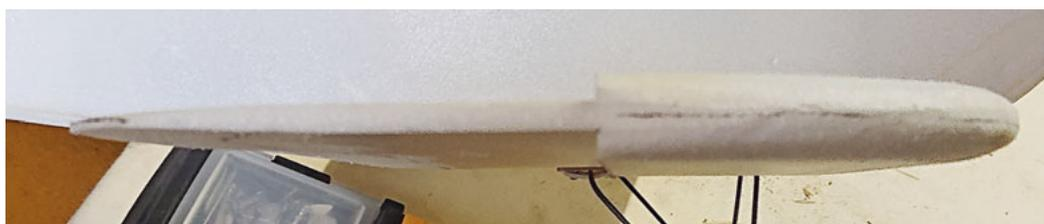
Profil KFM4 conçu pour une réalisation en Dépron.
