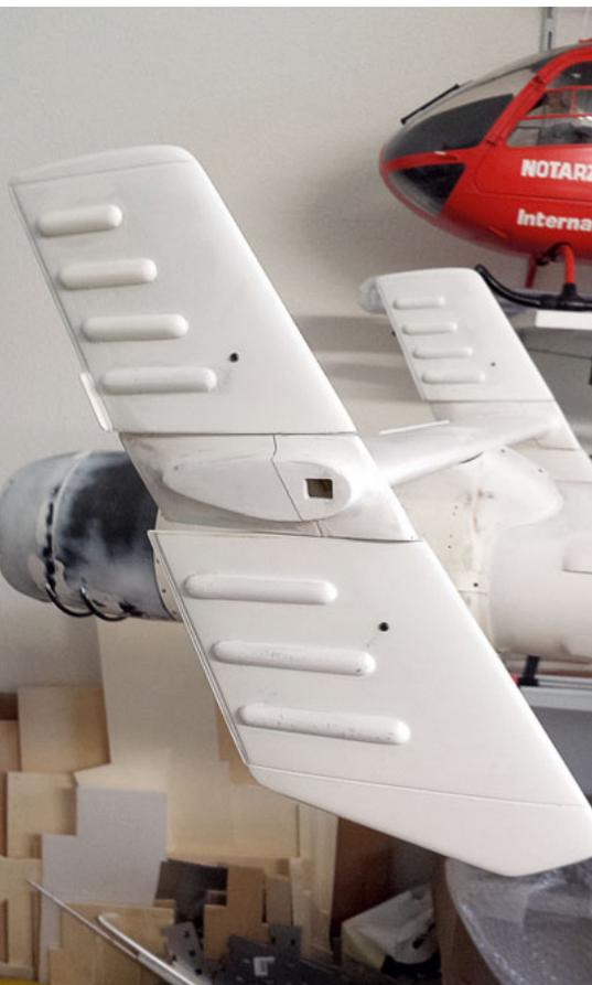
**Umbau von Höhen- und Seitenleitwerk im Rohbau.**
