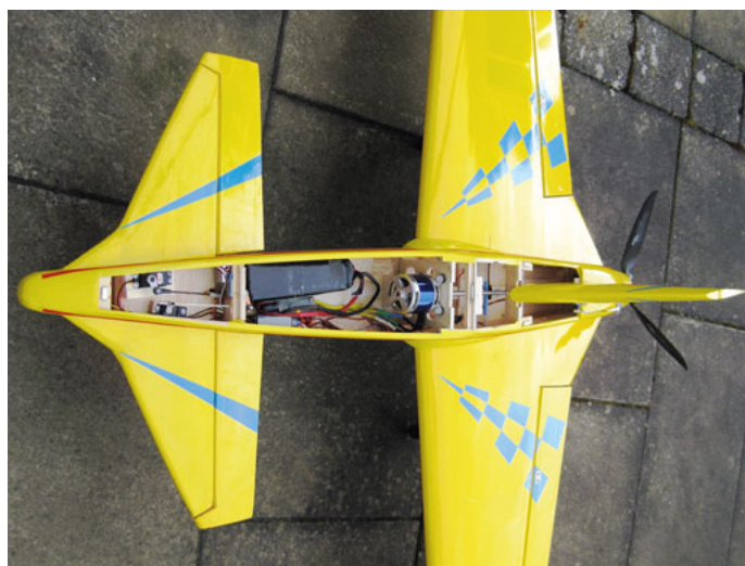
Aus Schwerpunktgründen musste der Motor in die Rumpfmittle wandern.
