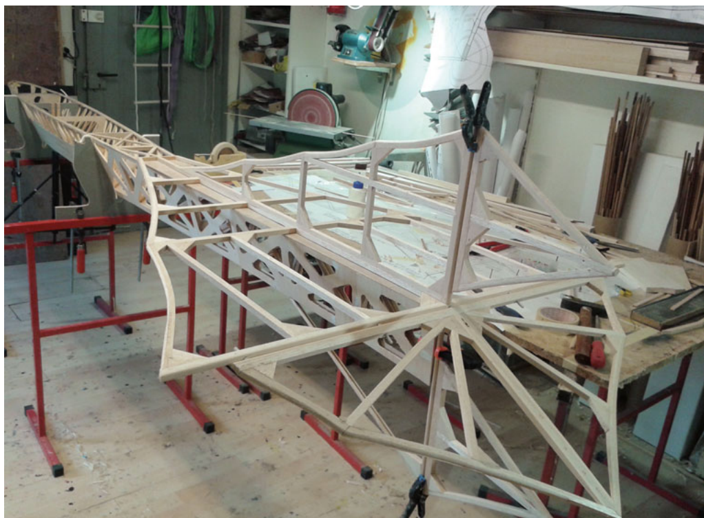
Das Höhenruder / Seitenruder ist eine demontable komplette Einheit aus Balsa. La gouverne de profondeur / direction est un ensemble complet démontable en balsa.
