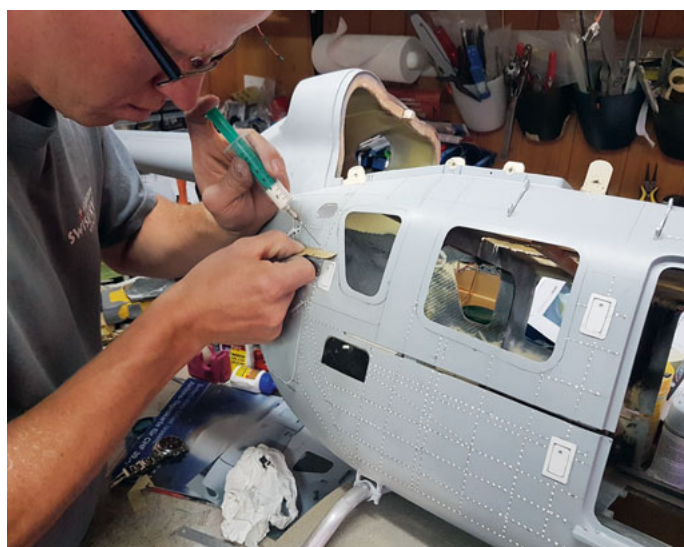
Im Akkord werden Nieten angebracht.
