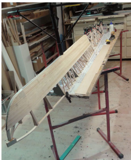
Der schiffsförmige Rumpf wurde kopfüber in Stäbchenbauweise aus Fichte erstellt. Die Beplankung am vorderen Teil des Rumpfes ist aus 2-mm-Fichtenstreifen.
