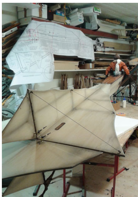
Die Höhenruder-Seitenruder-Einheit, mit Solartex bespannt, wurde authentisch leicht gealtert. L'unité profondeur / direction, recouverte de Solartex, a été légèrement vieillie de manière authentique.
