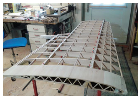
Die Flügel entstehen. Besonders auffällig ist die erste Rippe, diese wurde dem Original nachgebildet und war nicht verkleidet. Construction des ailes. La première nervure est particulièrement frappante, elle a été copiée à partir de l'original et n'a pas été coffrée.
