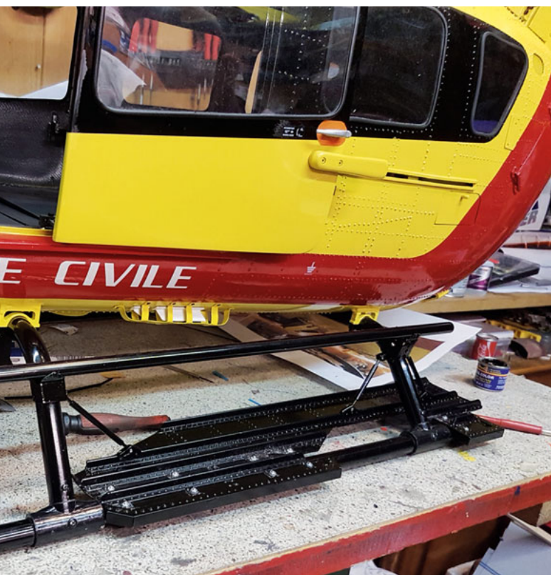
Der fertige Einsinkschutz sowie die Kabelabweiser.
