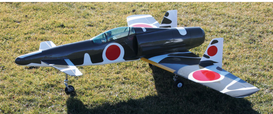
Shinden-Nachbau mit 90-mm-Impeller und Einziehfahrwerk. Das Bugfahrwerk wurde später weiter nach hinten verlegt, um die Steuereigenschaften auf Rasenpiste zu verbessern.
