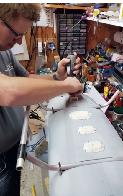
An der Unterseite werden die Antennen montiert.
