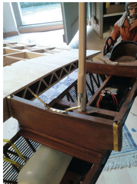
Die Flügelaufnahmen und der Hauptträger sind konstruktiv wie beim Original gestaltet. Les supports d'aile et la poutre principale sont conçus comme l'original.
