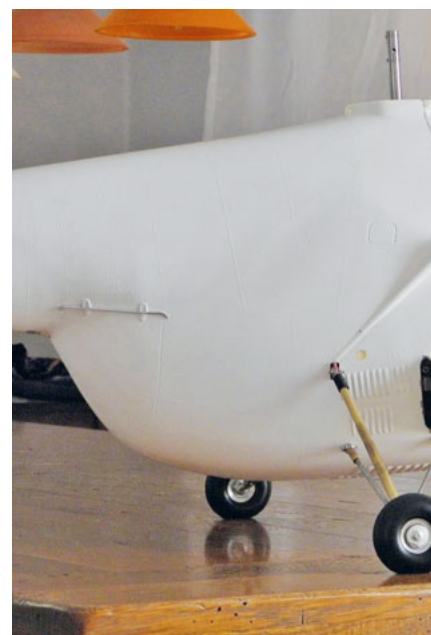
Das Fahrwerk, in vielen Arbeitsstunden vom Erbauer selber hergestellt. Schön zu sehen einige von den 20000 Nieten auf dem Rumpf.
