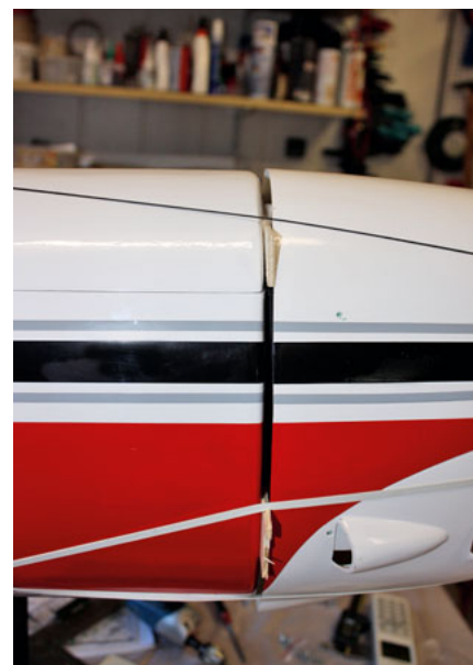
Passgenaues Anbauen der GFK-Motorhaube unter Zuhilfenahme der vorhandenen Dekorlinien. Man achte auf den Luftschlitz zwischen Rumpf und Nase.
