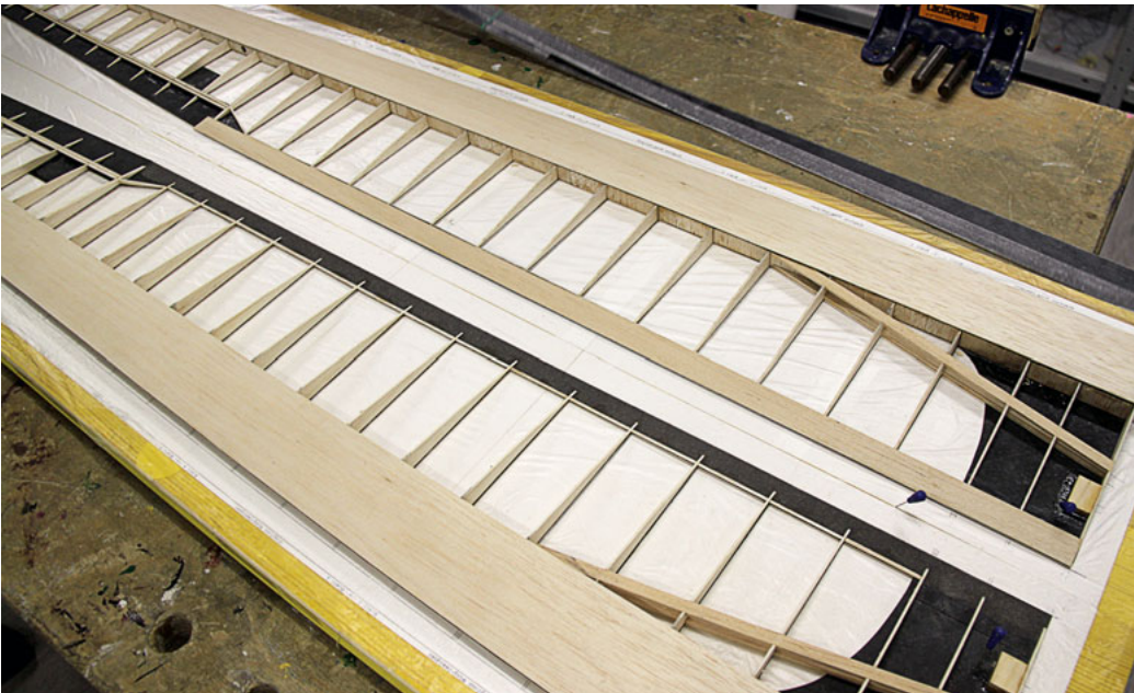
Ein Blick auf das schwarze Kohlefaser-Innenleben des Flügels.
