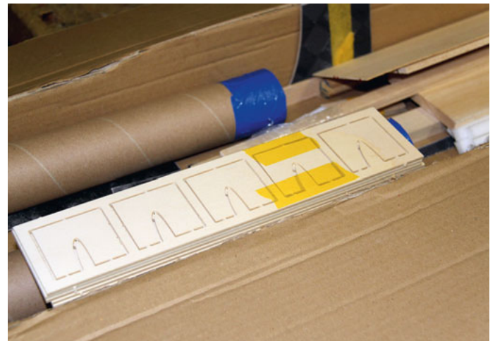
Schablonen erleichtern die Profilierung des Flügels.
