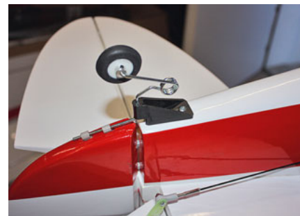
Drahtgefedertes Spomrad – nicht scale, aber funktional.
