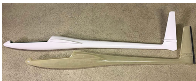
Der originale Cirrus-Rumpf (oben) im Vergleich zum Rumpf des Prototyps (unten).
