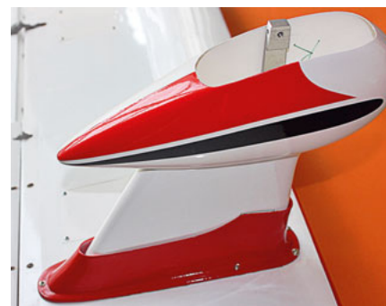
Starres Fahrwerksbein, eigentlich flexibler, weil zweiteilig ausgeführte Verkleidung. Da liesse sich noch was machen.
