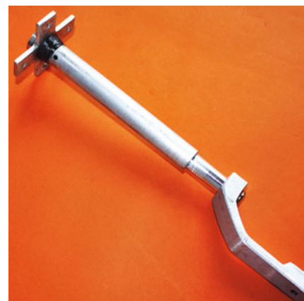
Teleskopfederbein nach Versteifung mittels CFK-«Schalkragen».
