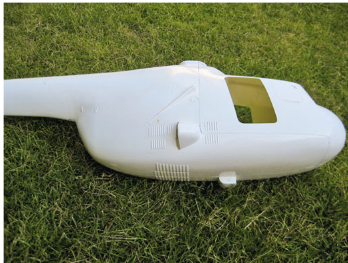
Frisch aus der Form, der fertige Rumpf. Schön zu sehen die vielen Details auf dem Rumpf.
