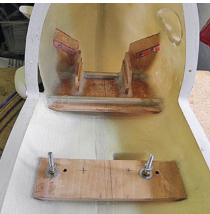
Fertig eingeharzte Mechanikaufnahme im Rumpfboden.
