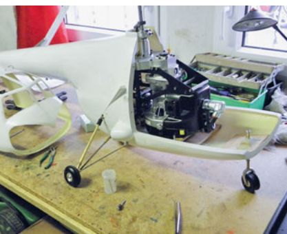
In der ersten Ausführung kam eine Benzinmechanik mit einem ZG-23 zum Einsatz.
