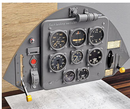
Instrumentenbrett im Selberbau. Tableau de bord «fait maison».
