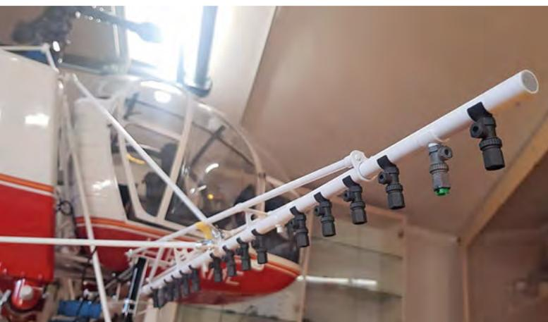
Fertig montierter Ausleger mit den Sprühdüsen.
