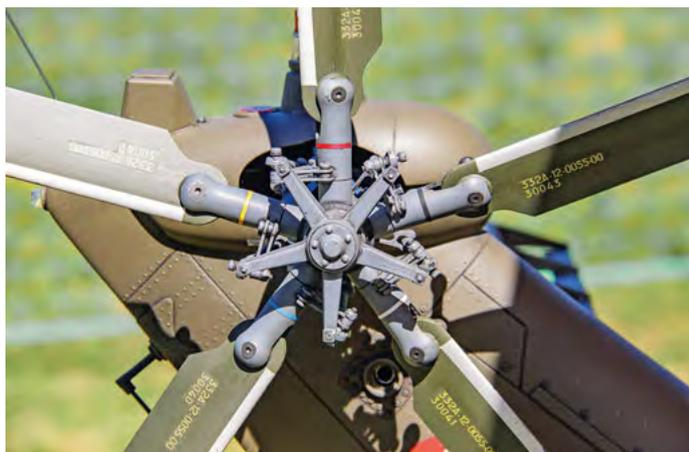
Rotore posteriore di un Super Puma.
