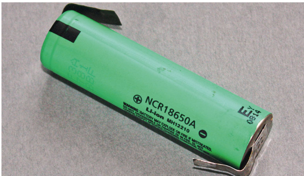
Alles begann mit der 18650. Moderne Zelle mit 3,1 Ah und moderater 2C-Belastbarkeit.
