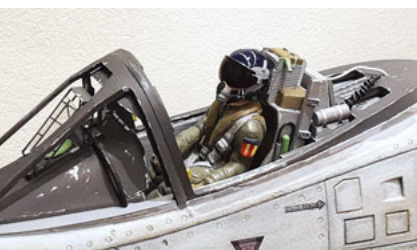
Auch das Cockpit stammt aus dem 3D-Drucker von Andreas.
