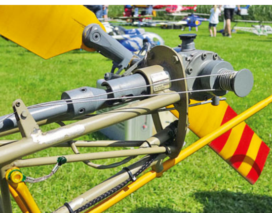
Typisch bei der Alouette II: der Zweiblatt-Heckrotor und die Ansteuerung mittels Seilzug.
