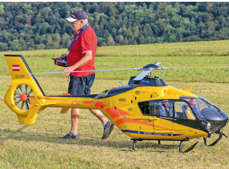
Loorholz-Flugtage: Der Turbinenhersteller Gerhard Pahl aus dem österreichischen Linz hatte seine EC 135 dabei, angetrieben von einer 2-Wellenturbine mit 12 kW; Gewicht 50 Kilogramm, Rotordurchmesser 3,2 Meter.
