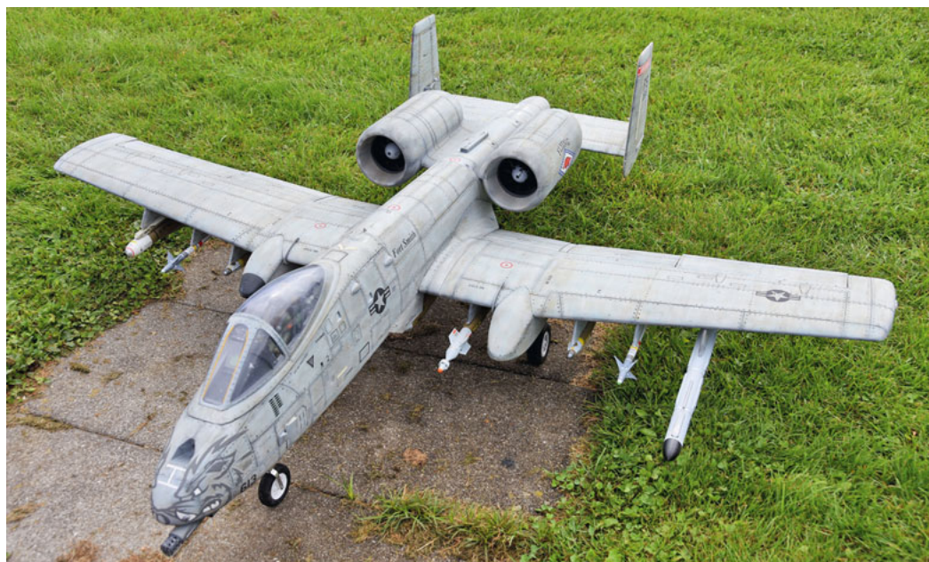
Diese Thunderbolt II A-10 Flying Razorbacks ist von Andreas Kees mit viel Aufwand und Talent aufgepeppt worden. Spannweite 1700 mm, Gewicht ohne Bewaffnung 5,9 kg, die zwei 80-mm-Impeller werden mit je einem 6S-5000-mAh-Lipo-Akku mit Energie versorgt.
