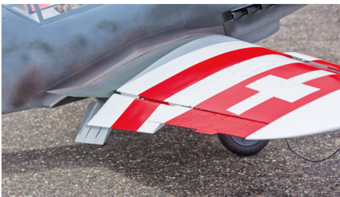
Tragfläche mit Vorflügel, Kühlerklappe (innen), Landeklappe (mittig) und Querruder (aussen).
