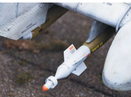
Dank 3D-Drucker wurde die gesamte Bewaffnung massstabgetreu realisiert.
