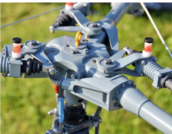
3-Blatt-Rotorkopf – eine technische Meisterleistung.
