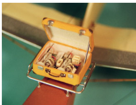
Beherbert Elektronik und Linear-Servos. Compartiment pour l'électronique et les servos linéaires.
