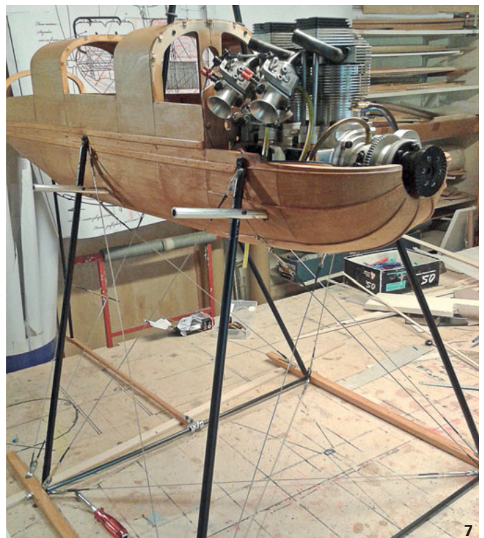
Kolm-IL130-135-ccm-2-Zylinder-Reihenmotor mit Bordanlasser.
