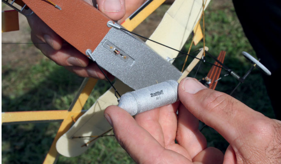
Eine LiPo-Zelle mit 150 mAh im Tank. Dans réservoir une cellule lipo de 150 mAh.
