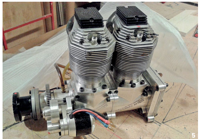
Kolm-IL130-135-ccm-2-Zylinder-Reihenmotor mit Bordanlasser.
