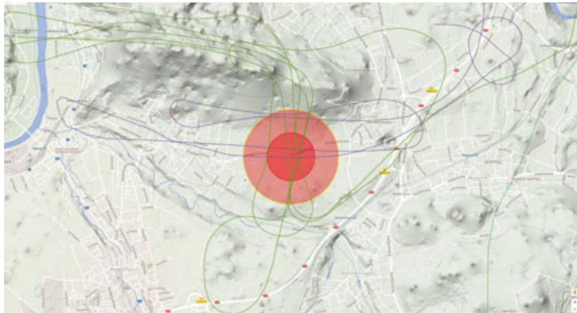
Flugwege beim ersten Test. Grüne Linie: Flugweg Motorflugzeuge, violette Linie: Flugweg Segelflugzeuge innerer, dunkelroter Kreis (Radius und Höhe einstellbar): In diesem Zylinder erfolgt eine Warnung der anfliegenden bemannten Fluggeräte, äusserer hellroter Kreis (Radius und Höhe einstellbar): In diesem Zylinder erfolgt eine Warnung der Modellflieger am Boden.
