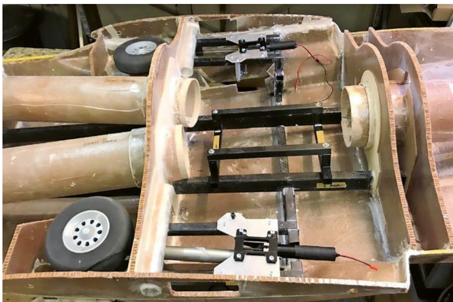
Blick in den Rumpf mit den Luftkanälen für den Senkrechtstart. Vue du fuselage avec les canaux d'air pour le décollage vertical.
