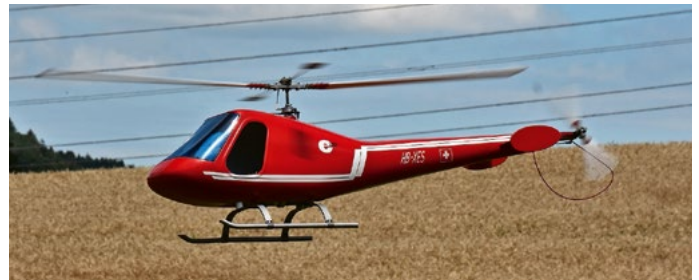
Andi Kessler flog diesen uralten Schlüter-Heli, ohne Blattverstellung, hier wird noch alles mit dem Gas geregelt.
