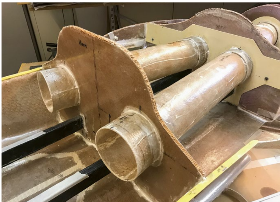
Blick in den Rumpf mit den Luftkanälen für den Senkrechtstart. Vue du fuselage avec les canaux d'air pour le décollage vertical.
