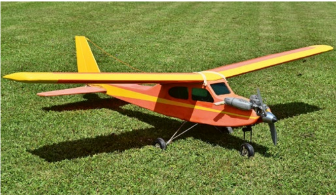
Der Originalcharter des Autors, vor mehr als 50 Jahren aus einem Robbe-Baukasten erbaut, mit Seide bespannt und lackiert. Geschaffen für die Ewigkeit.
