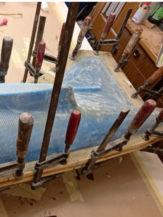
Des moules ont été créés à partir des pièces fraisées en styrène.
