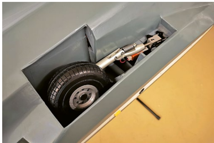
Elektron-ER-30evo-Mechanik mit Jet-1A-Fahrwerksbein. Anders als beim Original wird es nach hinten eingezogen.
