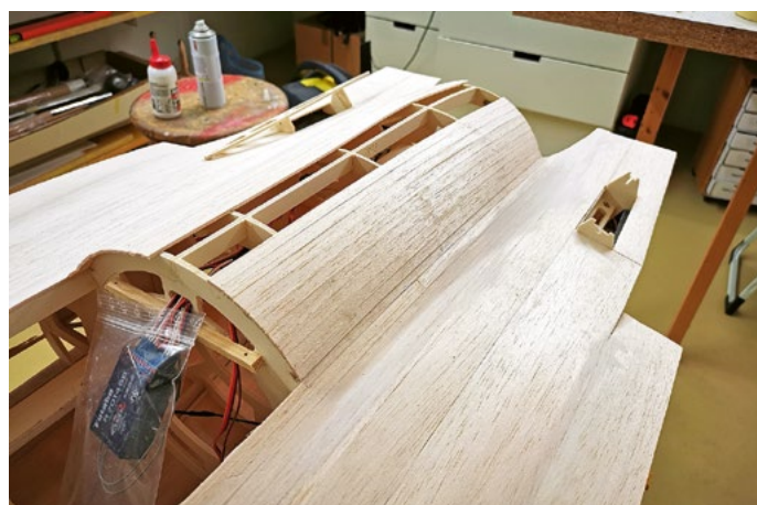
Die Beplankung war eine aufwendige Arbeit. Je präziser gearbeitet wird, desto besser das Resultat.
