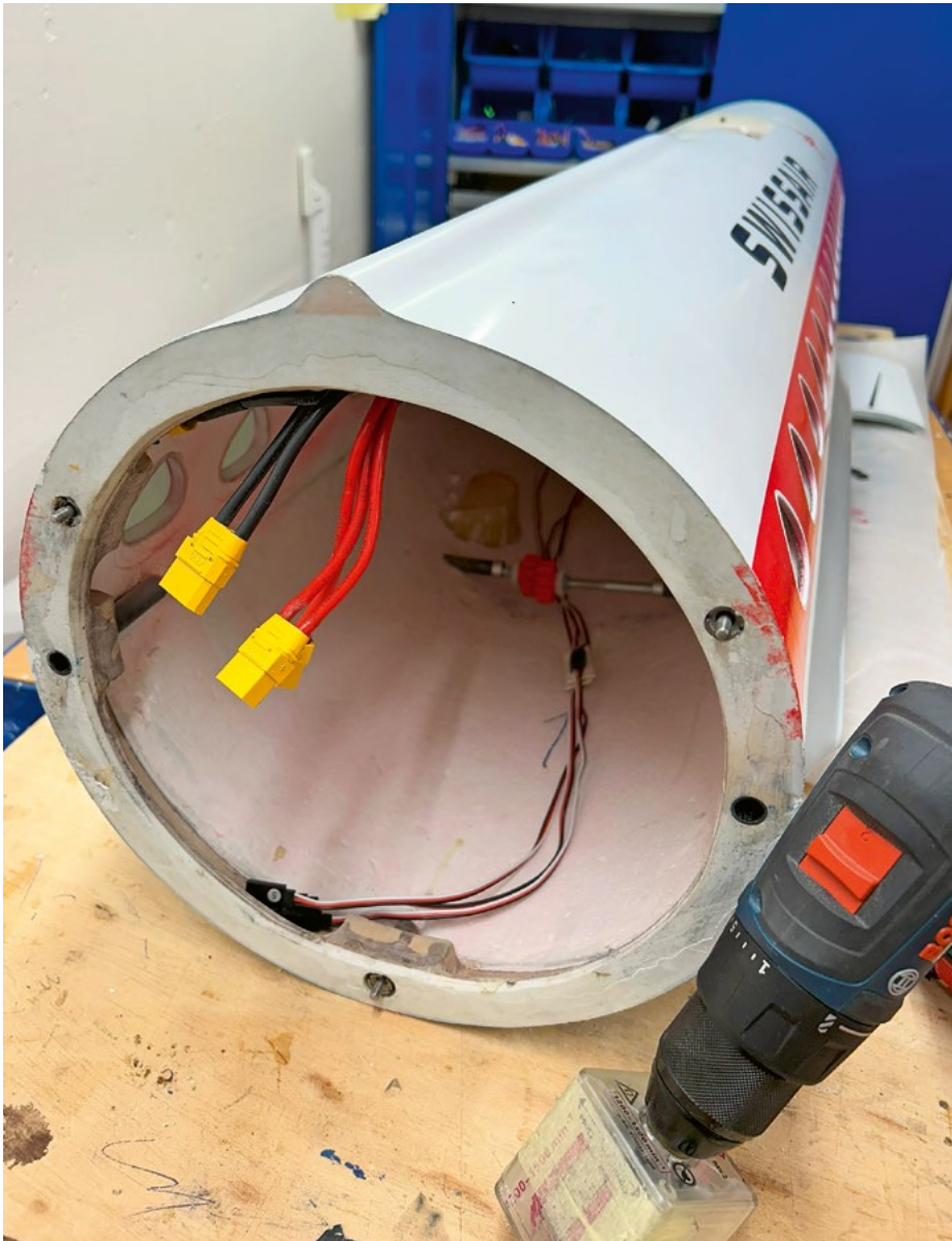
Die drei Gewinde der Magnetschrauben. Mit dem Magneteinsatz an der Bohrmaschine lassen diese sich «unsichtbar» mit dem Gegenstück verschrauben. Les trois filetages des vis magnétiques. L'insert magnétique dans la perçuse permet de les visser de manière «invisible» avec la pièce correspondante.
