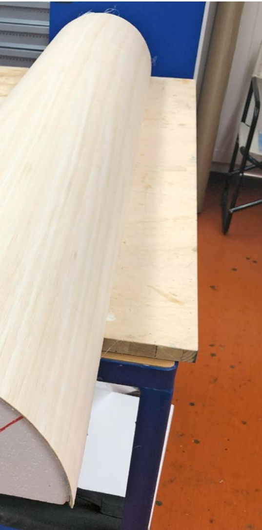
Coffrage en balsa 1,5 mm.
