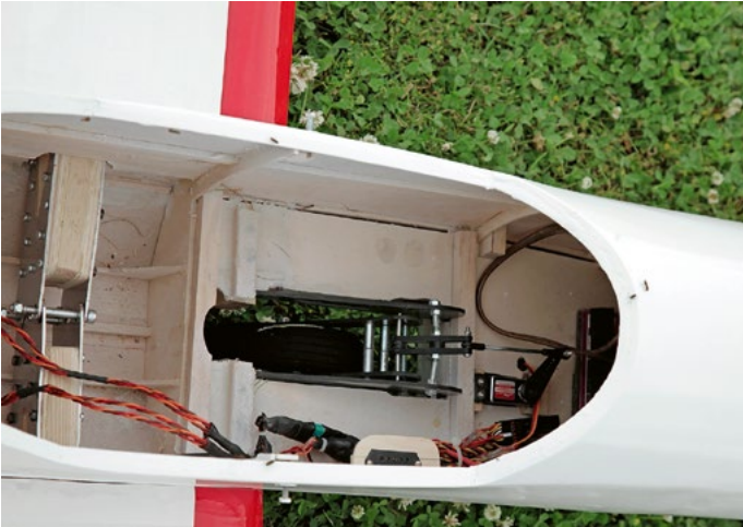
Schwimmende Lagerung der Flügel über Laschen plus M6-Schrauben. Anlenkhebel plus dessen Achse im CFK-Fahrwerk sind unterdimensioniert.
