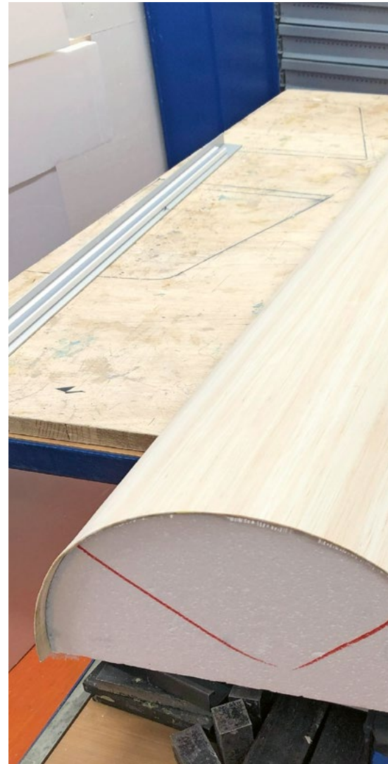
Mit 1,5 mm Balsa beplankt.
