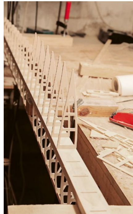
Zweiteiliger Flügel Aufbau: Rippen werden in Einschnitte des Holmes eingesteckt, getrennt nach vorderem und hinterem Anteil.
