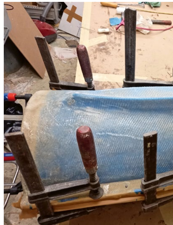
Aus den Styrofrästeilen entstanden Formen.
