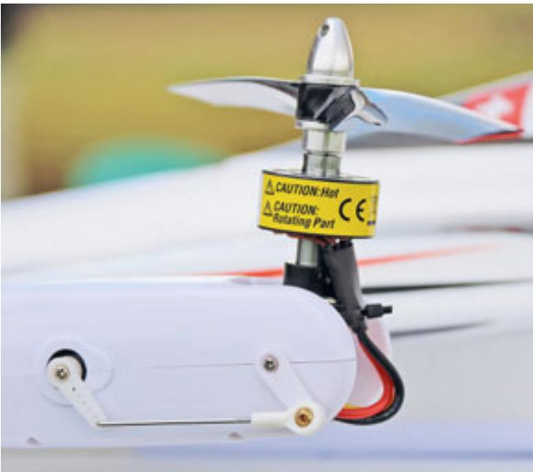
**Die beiden Frontantriebe sind schwenkbar und könnten bei einer Landung im Flächenflug-Modus beschädigt werden. Deshalb wird im Kopterflug-Modus gestartet und auch gelandet.**
