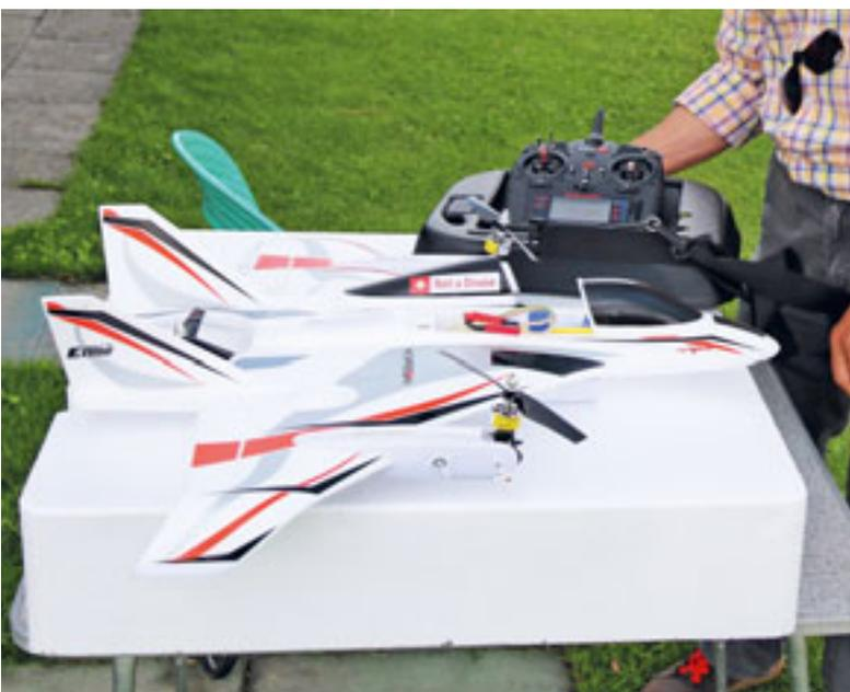
Zur Convergence VTOL in der BNF-Version gehört ein Spektrum DSM2/DSMX kompatibler Sender. Hier kommt die preisgünstigste Version, ein Air DX6 6CH DSMX, zum Einsatz.
