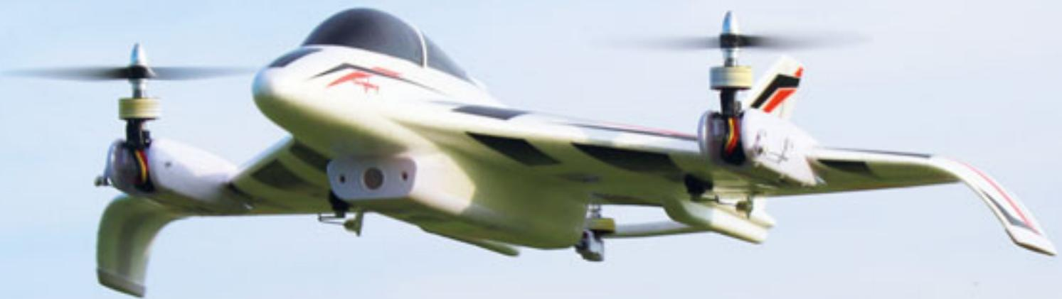
Die Convergence VTOL ist bereits mit einem Fach für die Aufnahme einer VPV-Anlage ausgestattet. Ob sich das nicht gerade einfache fliegende Ding dazu eignet, darf bezweifelt werden. Auf jeden Fall hatte der Autor genug damit zu tun, das Modell für den einwandfreien Flugbetrieb zu trimmen und verzichtete bisher auf den FPV-Einsatz...
