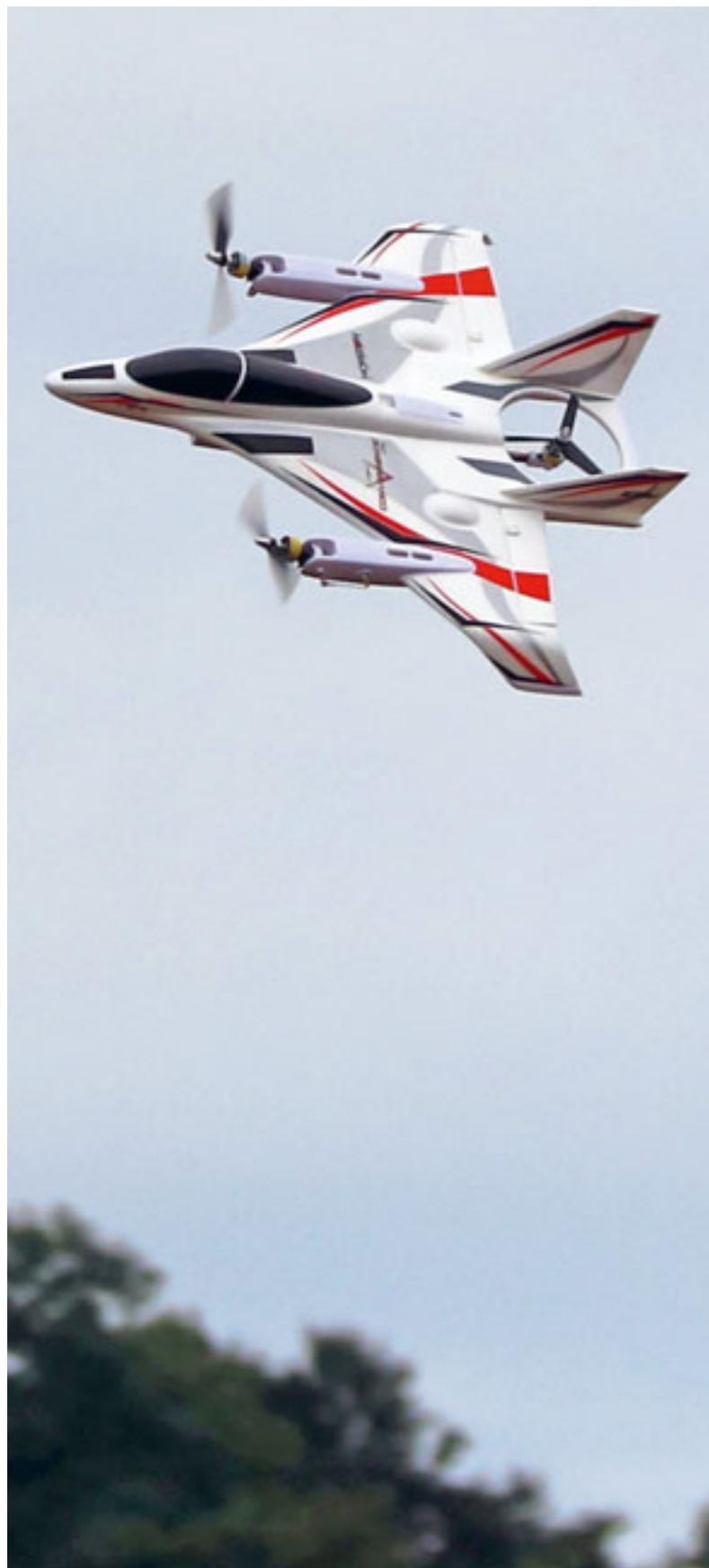
Im Flächenflug-Acro-Modus ist die Convergence VTOL ein kleines, schnelles Delta, das rasch ausser Sichtweite geraten kann. Der Heckantrieb ist im Flächenflug arbeitslos.
