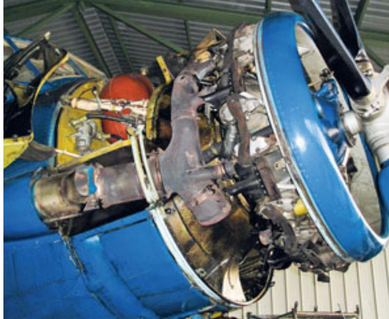
Das Original: Sternmotor mit 27 000 cm<sup>3</sup> in bester Form. Mit geöffnetem Motorraum. Das Bild ist in Ungarn entstanden.
