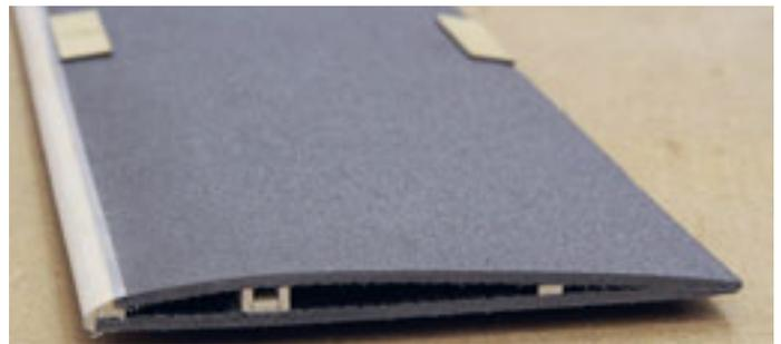
Coupe de l'aile terminée. Le BA est recouvert d'un papier collant. L'aile pèse 54 g.
