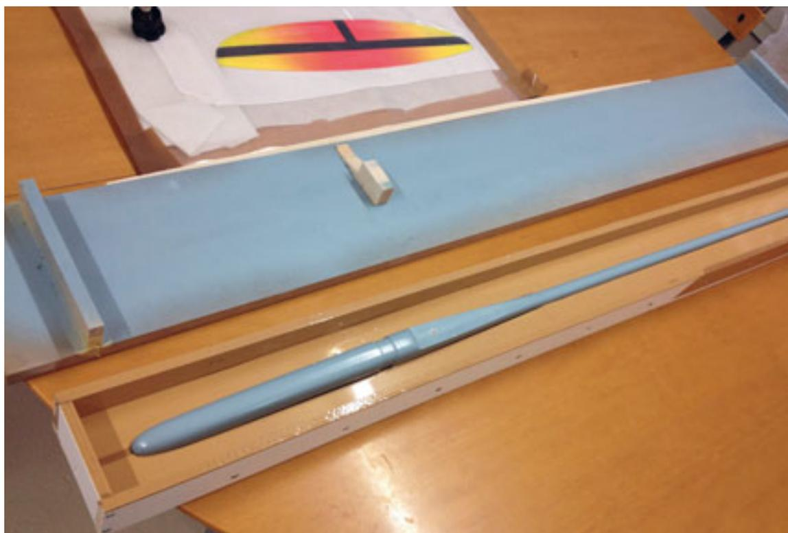
Construction du moule négatif de fuselage.
