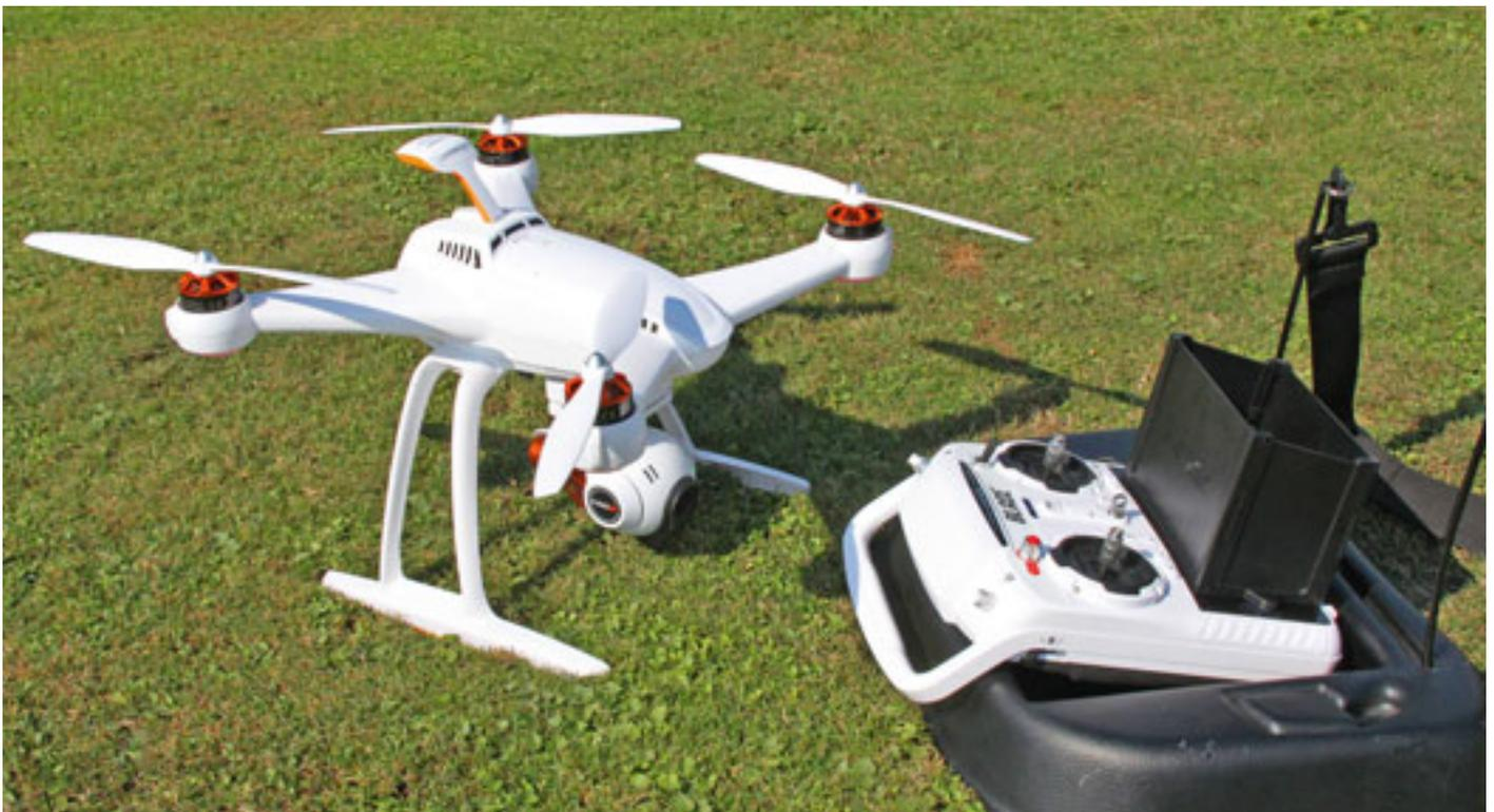
Alles dabei: Chroma-Drohne mit 3-Achs-stabilisierter Kamera vom Typ CGO2+ mit 16 MP (Foto) und 1080 p/60 (Video), plus ST-10+ Fernsteuerung mit integriertem Touch-Screen-Display.
