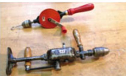
Handbohrmaschinen als Winder für Gummistränge:
