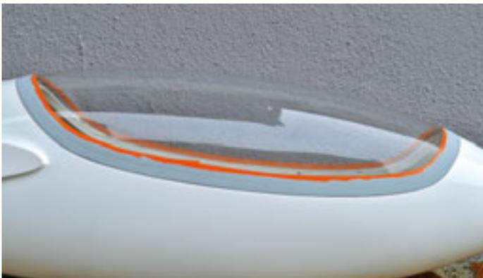
Überstände weggeschliffen, Haube abgeklebt, Füller drauf – noch nicht verschliffen, um erkennen zu können, ob die Passung gelungen ist.
