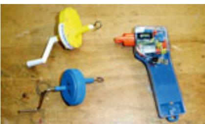
In Handel erhältliche Winder 1:5 und 1:10 sowie elektrisch angetrieben mit Zählwerk.
