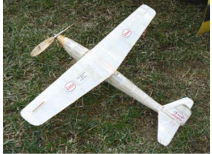
Baumaterial Sperrholz und Kieferleisten, Bespannung Seide, Antrieb 36 Fäden Gummi. Antikmodell Esso von A. Messmer 1939 konstruiert und nach altem Plan gebaut.
