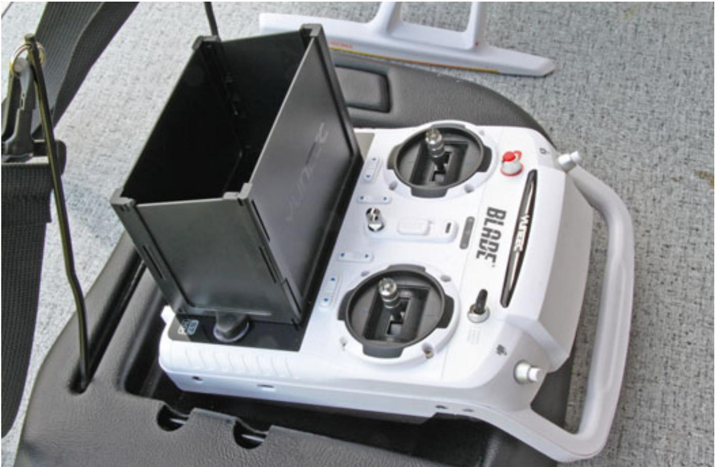
Fernsteuerung Blade ST10+ mit integriertem Display. Mit zusätzlichem Lichtschacht fast blendfrei.
