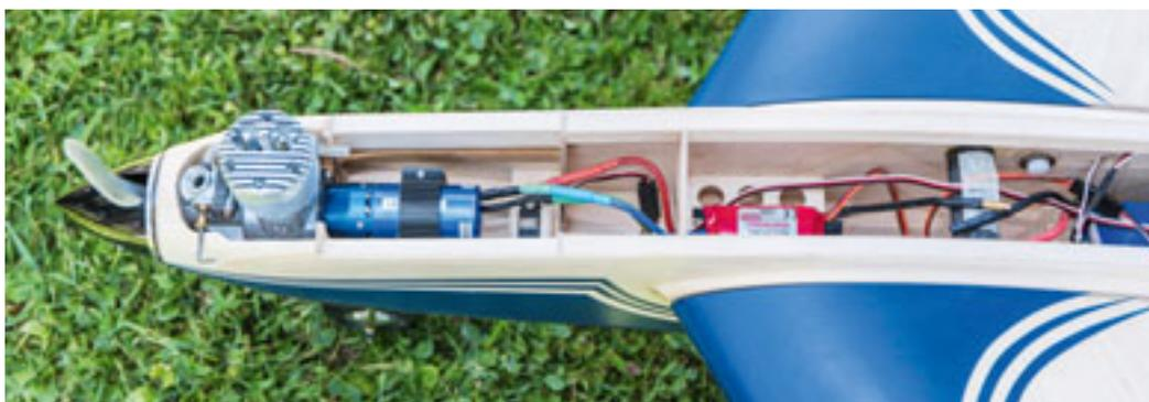
**Blick in die Technik des Modells: v. l. Super Tigre 56 mit angeflanschem Motor Leomotion mit Getriebe, Kontronik-Drehzahlsteller und Akku im Schwerpunkt.**
