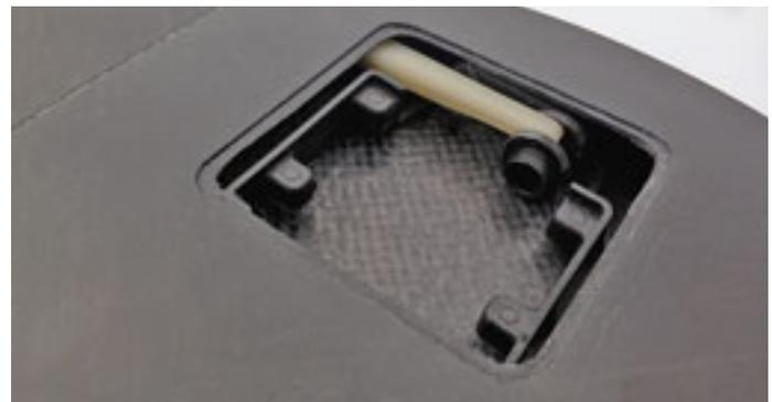
Fertig eingebaute LDS-Anlenkung mit Gegenlager für Futaba S3173.
