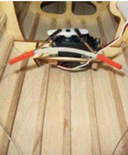
Fahrwerk eingefahren, Saiten sind durch Entspannen des Kabelbinders gestreckt (zurückgezogen).
