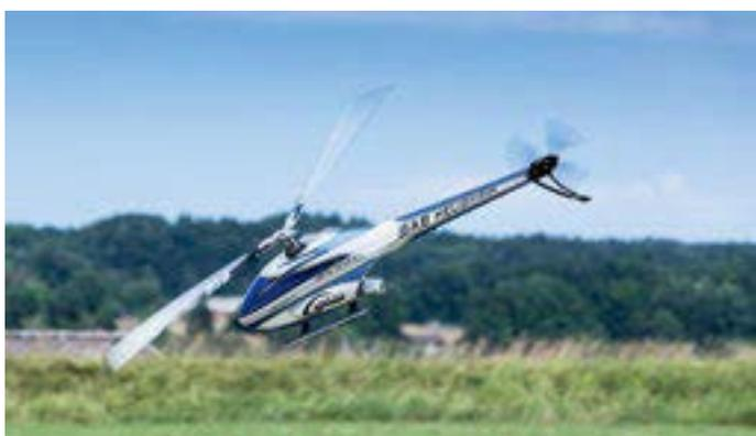
Goblin Urukay hier als Beta-Version mit dem neuen Dreiblattrotor zu sehen. Für F3C ist vor allem eine hohe Präzision bei der Ansteuerung von Haupt- und Heckrotor gefragt.
