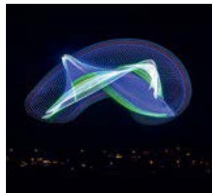
Die LED-Beleuchtung an den Rotorblättern in Kombination mit den zusätzlich am Rumpf angebrachten Leuchtbandern erzeugt komplexe Leuchtspuren am Himmel, die dank verschiedener Farben den räumlichen Flugverlauf mindestens erahnen lassen oder diesen sogar nachvollziehbar machen.
