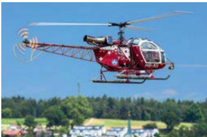
Lama SA 315 B, das Vorbild, steht noch immer bei der Air Zermatt im Einsatz, hier im Massstab 1:4 und mit einem Rotordurchmesser von 2,5 m sowie einem Fluggewicht um 20 kg. Der Pilot Stanislav Brož ist damit aus Tschechien angereist.
