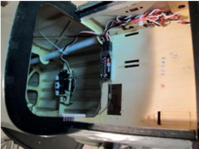
Empfänger-Einbau im Rumpf (Antenne korrekt verlegt).
