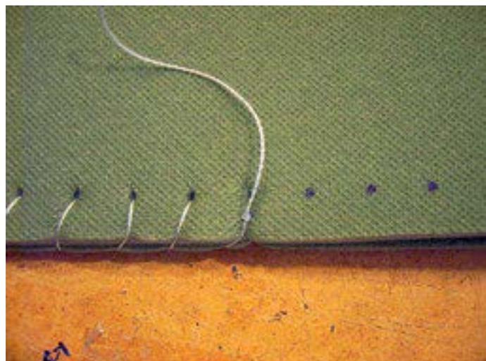
**Bild 3: Dann habe ich von oben durch den 2. Punkt durchgestochen, die Schnur aussen rumgeführt und von oben in den 3. Punkt gestochen usw. Den ersten Teil der gesamten Naht habe ich mit 1 m Schnur gemacht, was ca. 30 cm Naht ergeben hat. Dann geknüpft, damit die Naht geschlossen bleibt. Man kann den Faden gut stramm halten, aber wer zu stark zieht, zerreisst die Matte.**
