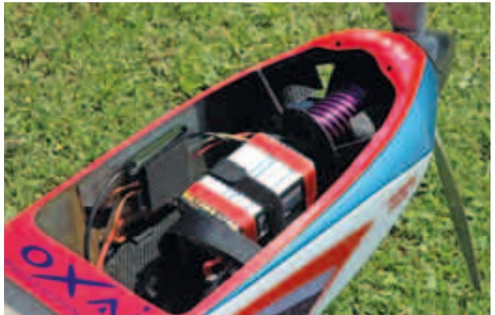
Umbau: Am Anfang wurden die Akkus unten montiert – später von oben zugänglich.
