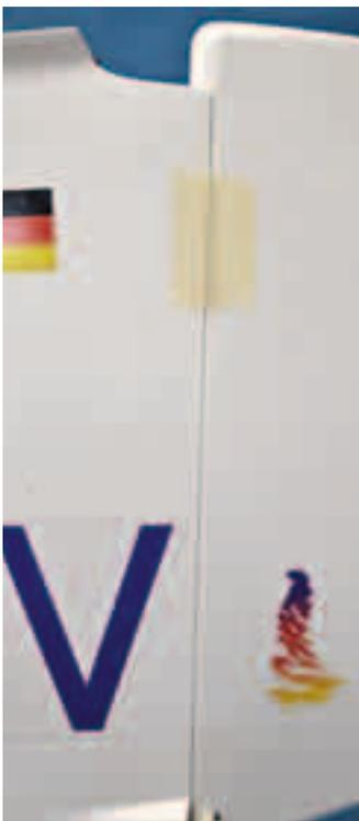
In die Löcher im Drucksteg wurde eingedicktes Harz eingebracht, die Ruderblatt-Lagereinheit eingesteckt und mit Kreppband mittig fixiert.
