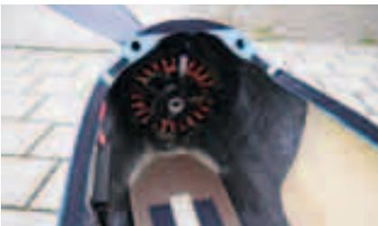
Ab 2010 kamen die grossen Aussenläufer zum Einsatz. Sie brachten das nötige Drehmoment ohne Getriebe (-Verschleiss).
