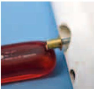
Die Drehteile stecken im Lagerdraht des Seitenruderblatts zwecks Einstellung.
