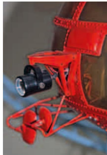
Suchscheinwerfer und Unterlastenspiegel in Perfektion.
