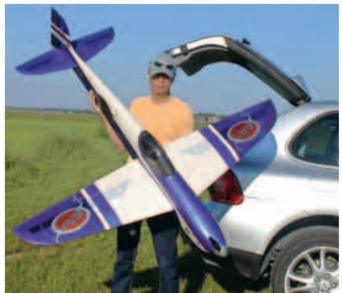
**F3A-Modell E-Factor ganz aus Holz von Michael Ramel. Abfluggewicht 4,4 kg. 30 NiMH Zellen (1,8 kg). Motor Lehner LMT 1940 mit Getriebe 6:1. 7000 U/min. am Propeller gemessen.**
