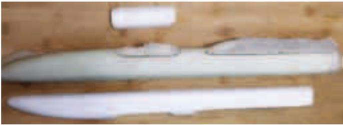
Dann werden die 2 Hälften zusammengefügt und verschliffen.
