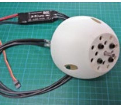
Die Motoreinheit mit Lüftungslöchern und dem Regler.
