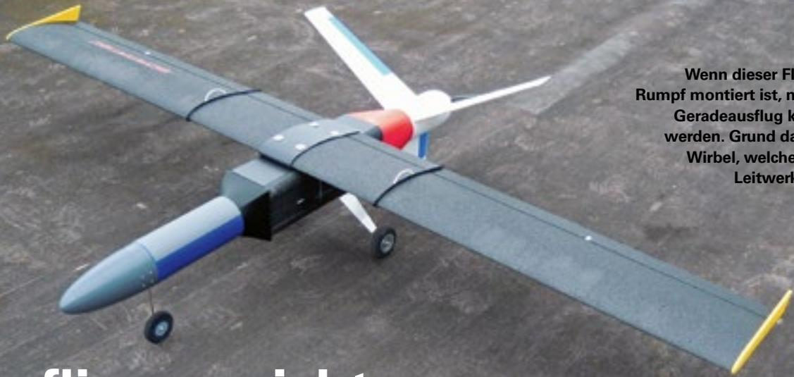
Wenn dieser Flügel am Rumpf montiert ist, muss der Geradeausflug korrigiert werden. Grund dafür sind Wirbel, welche auf das Leitwerk treffen.
