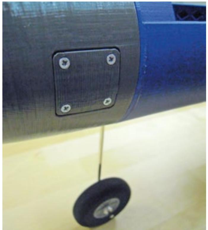
Bei abgeschraubtem Deckel kann hier der Canardflügel mit dem Pitotrohr montiert werden.
