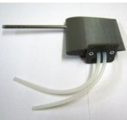
Canardflügel mit Pitotrohr.
