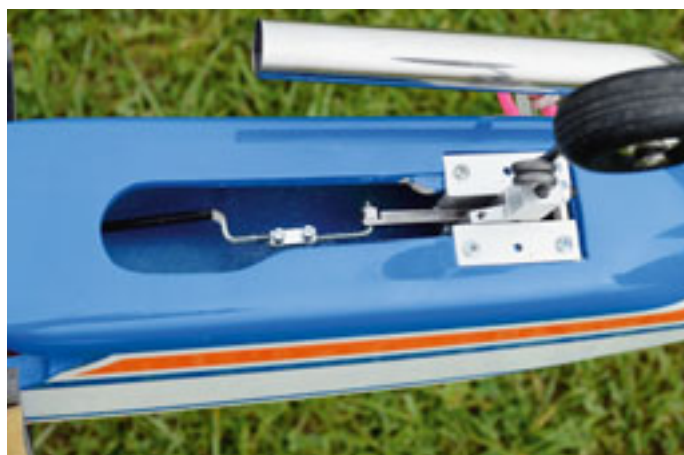
Verkörpert traditionelle Tugenden: das mechanische Einziehfahrwerk von Kenner.
