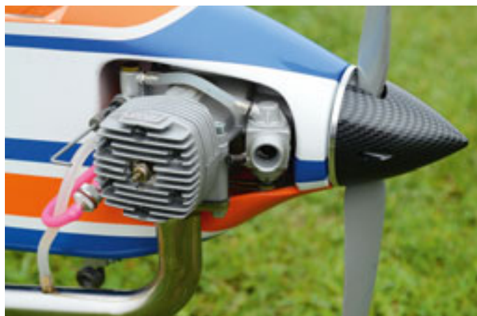
Der klangstarke Zweitakter bietet ein intensives Sounderlebnis, und der Krümmer wurde bei Zimmermann auf Mass gefertigt.
