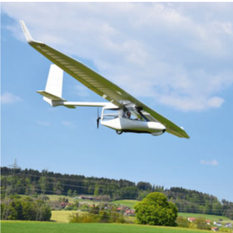
Der sehr leichte manntragende Elektrosegler Archaeopterix flog von Mollis nach Pfäffikon mit einer Batterieladung.
