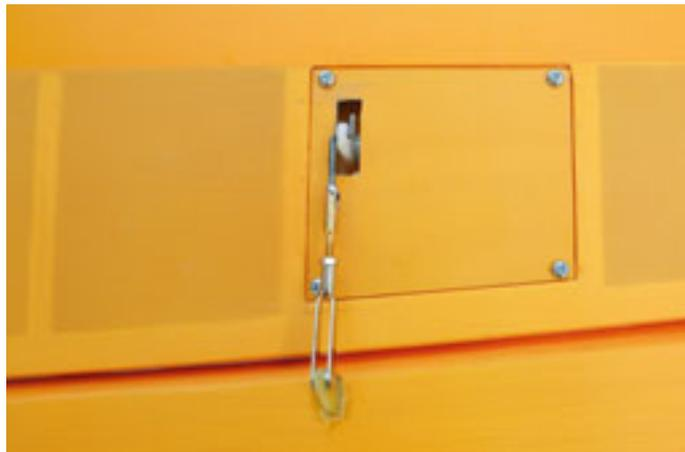
Der Ausschnitt für den Servoantriebshebel im fertig bespannten Deckel ist vom Modellbauer zu schaffen.
