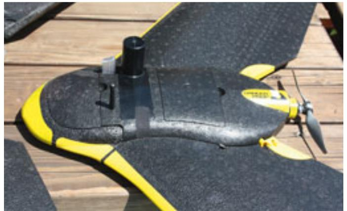
L'eBee RTK avec une antenne GPS de précision relié à une balise GPS au sol pour une précision de 2 cm. Toute l'électronique est dans le compartiment central.
