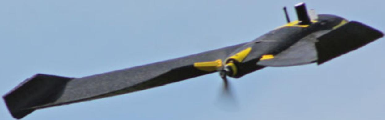
modèle simple donc léger. Le bilan va en faveur du poids. On retrouve dans l'eBee, des éléments utilisés en modélisme: des accus LiPo 3S1300 mAh environ, un moteur brushless de 100 à 150 W, un variateur et des servos de qualité.
