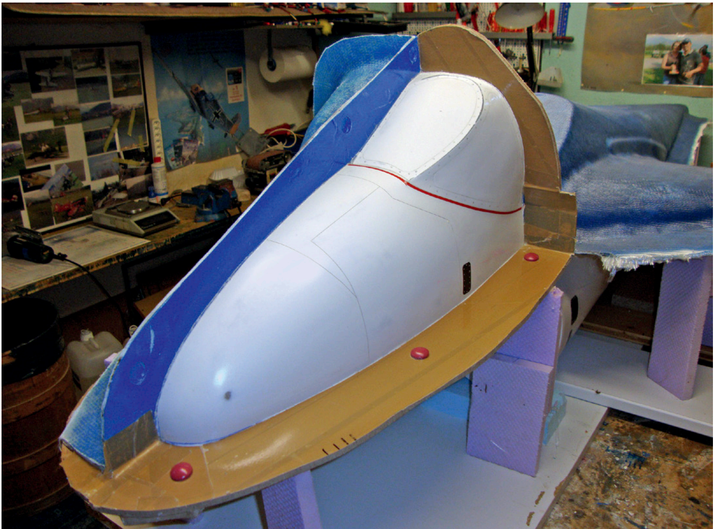
Fabrication des moules à partir d'un «Master».
