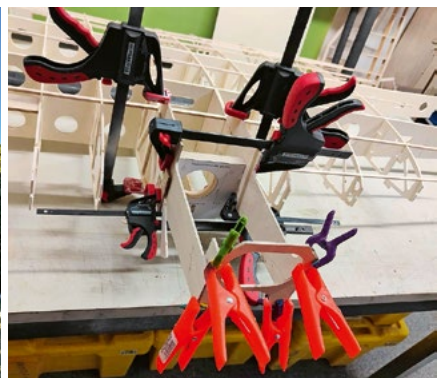
La section très rectangulaire facilite des assemblages à l'équerre, mais la structure très ajourée reste complexe.
