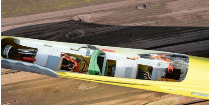
Dieses edel mit GFK-beschichtete Einbaubrett kommt fertig eingeharzt zur Kundschaft.
