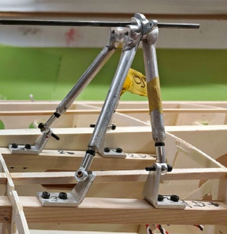
La structure est classique et légère en nervures CTP, longerons en bois semi coffré, tubes carbone pour la clé d'aile. Le profil de 17% et la dimension de l'aile garantit la solidité sans trop de renforts.
