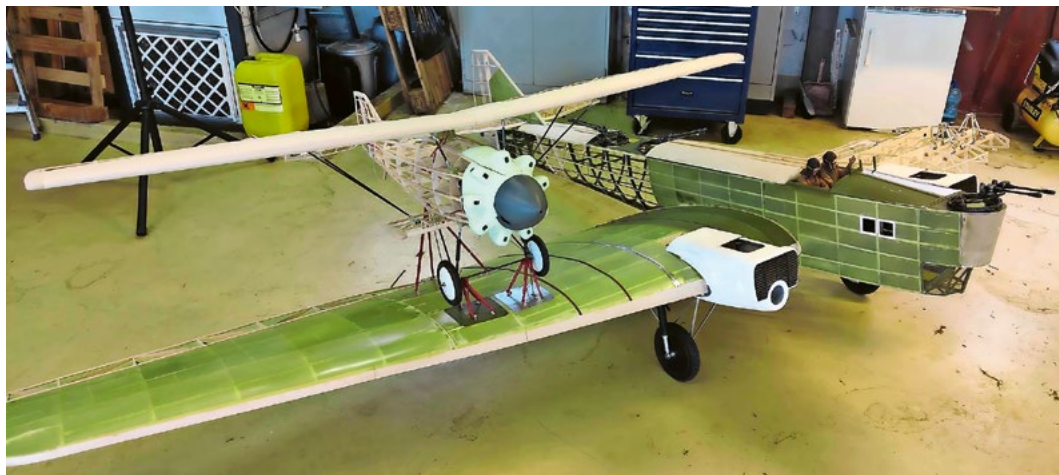
On comprend que le choix de la taille et l'échelle de l'avion porteur doit permettre un satellite de taille raisonnable: environ 1,90 m pour l'ANT5.
