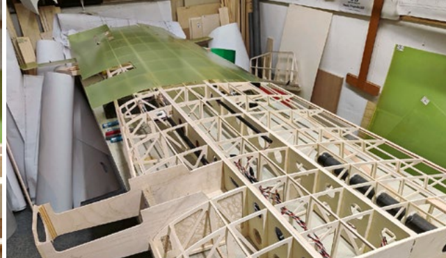
La structure est classique et légère en nervures CTP, longerons en bois semi coffré, tubes carbone pour la clé d'aile. Le profil de 17% et la dimension de l'aile garantit la solidité sans trop de renforts.
