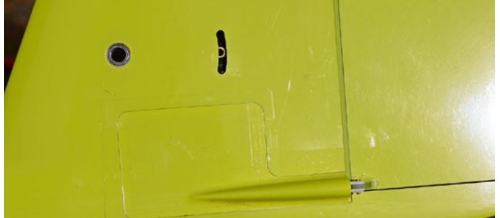
Unter diesem pfiffig gemachten Deckel verbirgt sich ein GFK-Umlenkhebel, werkseitig fertig angelenkt. Man beachte die Kugellagerung des vorderen Leitwerkverbinders.
