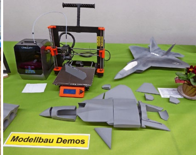
Ganzes Modell F-22 entsteht mithilfe vom 3D-Drucker.
