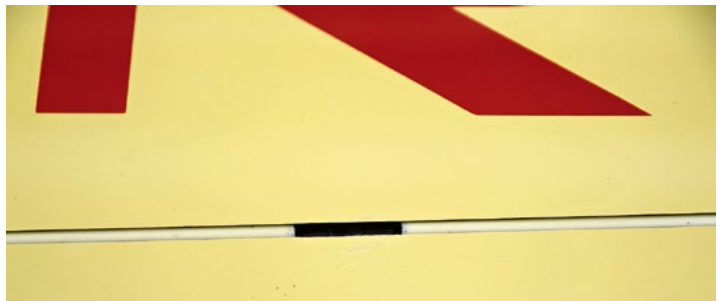
Dieser Ausschnitt ist in der Dichtlippe zu schaffen, um besagtes Einbauteil parallel und bündig zur Ruderante einharzen zu können.
