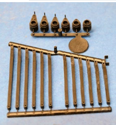
Servoantriebe und Schubstangen von RC-Rahmen.de. Wir brauchen den dritten (fürs Querruder) und vierten Servoantrieb (Wölbklappe) und die dritte und vierte Schubstange. Jeweils von rechts gesehen. Sie bestimmen die Servolage im Schacht.
