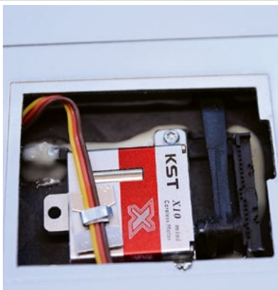
Kompletteinbau eines Flächenservos. Der Rahmen ist mit der Oberschale sauber verklebt, Kabel gegen Herumvagabundieren gesichert.
