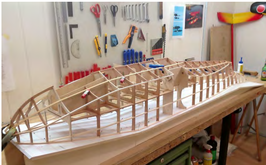
Aufbau der unteren Rumpfhälfte auf der Helling. Montage de la moitié inférieure de la coque sur la cale.
