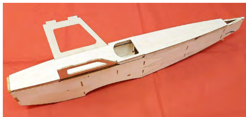
Der fertige Rumpf mit den beiden Baldachinstreben, Rumpfdeckel und oberer/unterer Beplankung ist bereit zum Bügeln.
