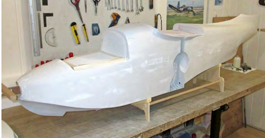
Langwieriges Grundieren, Spachteln und Schleifen. Apprêt, masticage et ponçage de longue haleine.
