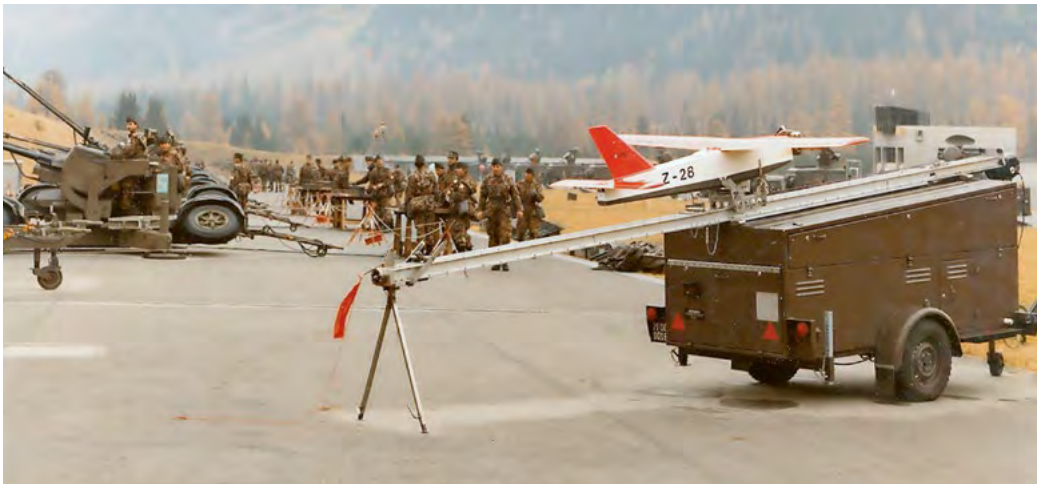
Drohnenstarttrampe im Rahmen eines Flab-Schiessens der Fliegerabwehrtruppe. Die Starttrampe ist auf einem Materialtransporter faltbar montiert. Der Wagen enthält alles wichtige (Ersatz-)Material für den Einsatz auf verschiedenen Plätzen.
