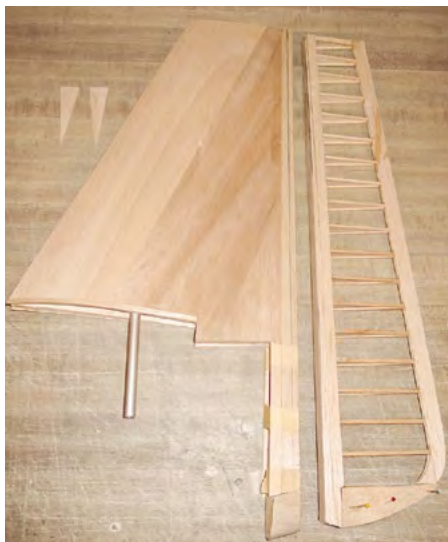
Seitenruder für spätere Coverall-Bespannung.
