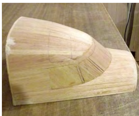
Am Rumpf herausgeschnittene Partie des Cockpits. Partie du cockpit découpée dans le fuselage.
