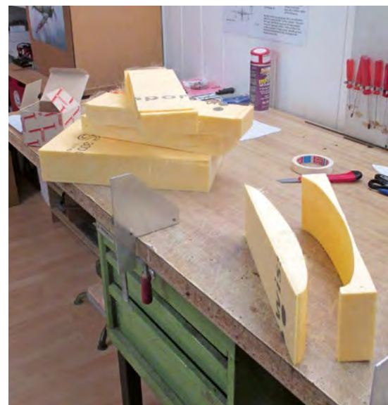
Styrofoam schneiden für die Stützwimmer.
