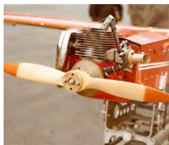
Motor 1 Zylinder Husquarna, 2-Takt mit mit ca. 11 kp Schub, gestartet mit einem Elektro-Anlasser.
