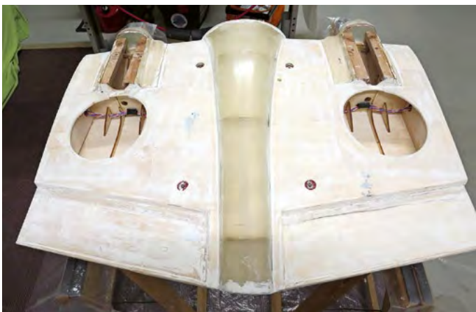
Tragfläche mit Rumpf, beglast und geschliffen.
