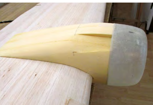
Styrofoam-Teile für die Motorgondeln. Pièces en Styrofoam pour les nacelles des moteurs.
