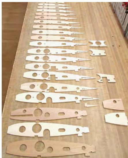
Gefräster Rippensatz für die rechte Fläche.
