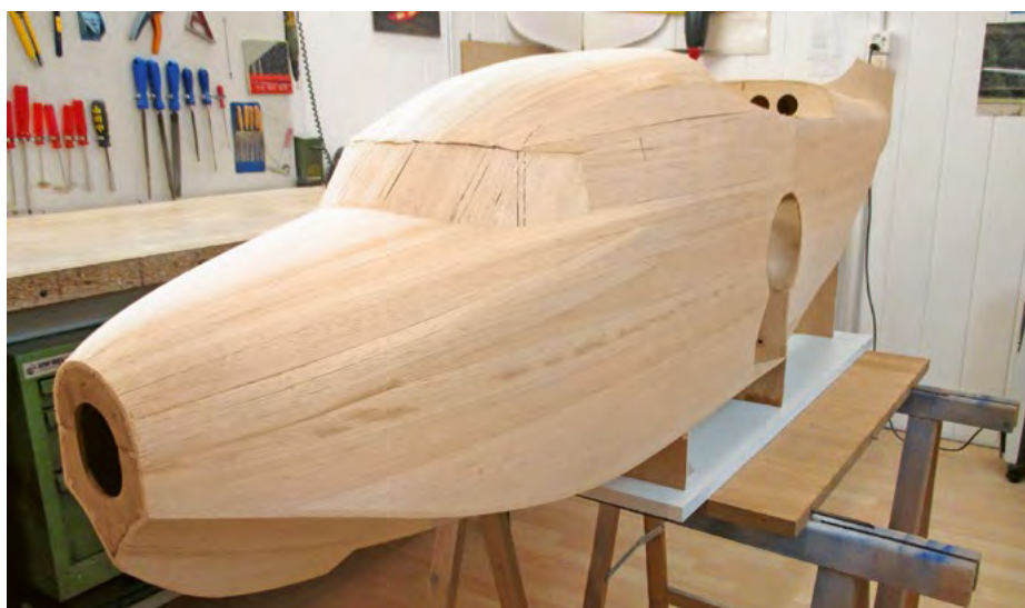
Gut zu erkennende Leistenbauweise am fast fertig beplankten Rumpf.
