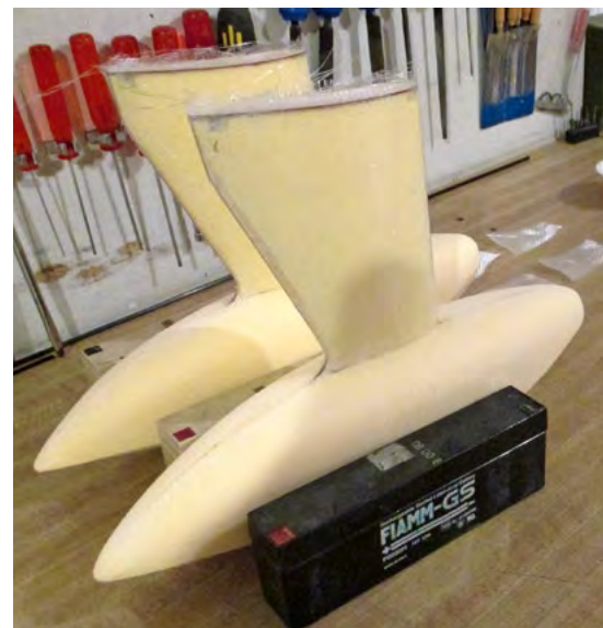
Bereits beglaste Stützwimmer. Flotteurs d'équilibre fibrés.
