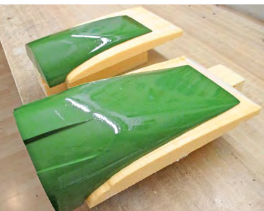
Mit Glasgewebe beschichtet, Oberfläche vorbereiten für das Abformen. Revêtue de tissu de verre, la surface est préparée pour le moulage.
