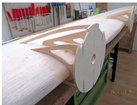
Träger und Brandschott für die Motoren. Support et cloison pare-feu pour les moteurs.
