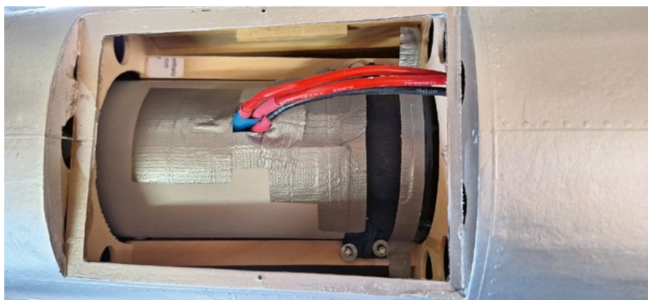
Zugang zum Impeller von unten am Rumpf. Accès à la turbine depuis le dessous du fuselage.
