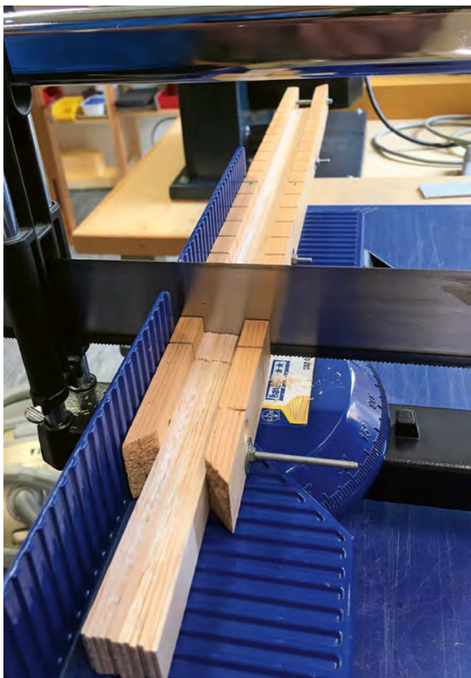
Bild 3: Die Rippenbrettchen werden mit der Gehrungssäge mithilfe eines «Kamms» als Schablone bis auf halbe Höhe eingesägt.
