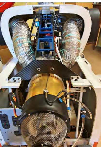
Mechanik mit 2-Wellen-Turbine Taurus 12 und Abgassystem.
