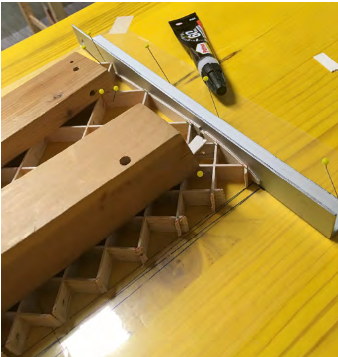
Bild 6: Verleimen einer Anschlussrippe, innen am rechten Flügelohrsegment.
