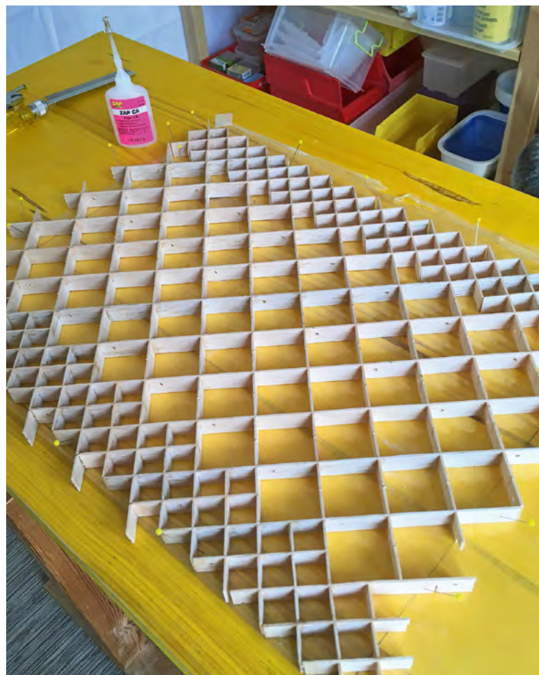
Bild 4: Zusammengestecktes und an den Kreuzungsstellen verleimtes Gitter mit 20 mm (Profil-Nasenbereich) resp. 40 mm Maschenweite.
