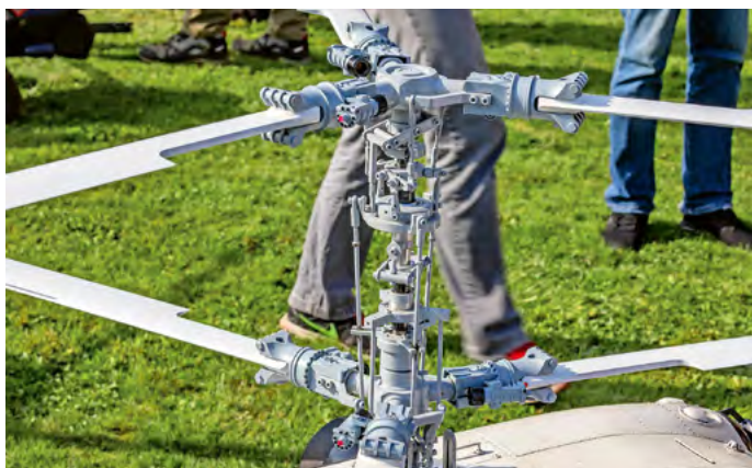
Montierte Rotorblätter am aufwendigen koaxialen Rotorkopf.
