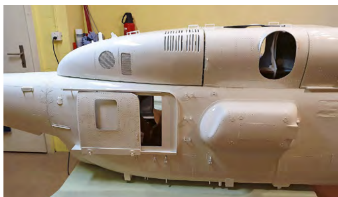
Alle Details sind am Rumpf angebracht. Grundierarbeiten sind abgeschlossen.
