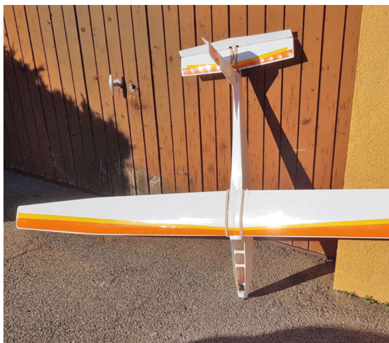
Le Moskito de Graupner, construit selon les plans de l'époque. Seul le profil a évolué en AG35. Les nervures sont en découpe laser.
