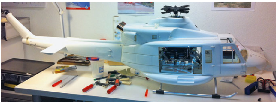
Die Turbinenmechanik JetCat PHT2 kurz vor der Demontage. Schön auf diesem Bild zu sehen, die Servicedeckel am Heckausleger.
