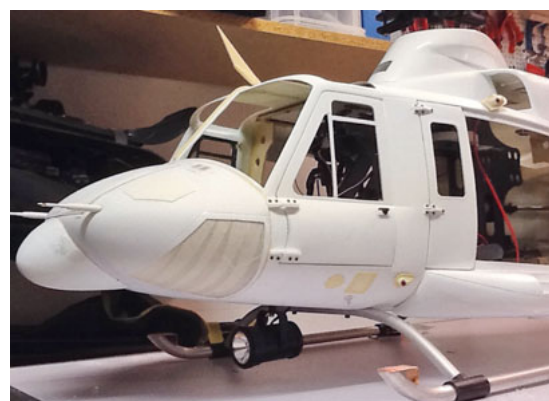
Scale-Bauteile Suchscheinwerfer, Kabelkapper usw. sind angebracht. Composants à l'échelle: projecteur, capuchon de câble, etc.
