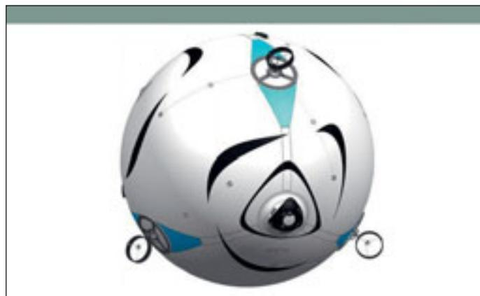
**Skye ist ein Flugroboter. Er besitzt eine mit Helium gefüllte Hülle und vier Flugplatten. Ebenfalls ist er mit einer Kamera ausgestattet. Gesteuert wird er per Touchscreen oder mit 3D-Maus.**
