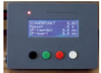
**Abb. 8: Anzeige des Gesamtgewichtes und der Schwerpunktlage.**
