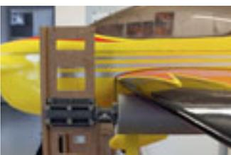
**Abb. 5: Einstellbare Anschläge für die Schwerpunktmessung.**
