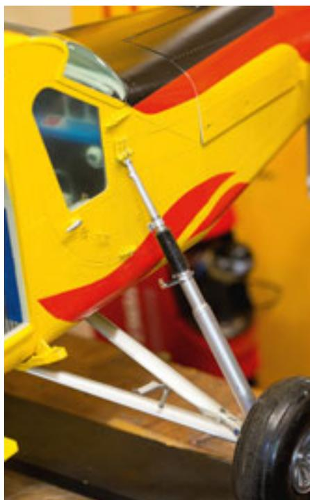
Links: Die Stossdämpfer im Hauptfahrwerk enthalten zusätzlich zur Spiralfeder auch noch einen Öldruckzylinder zur besseren Absorption der Aufprallenergie bei der Landung. Wie beim Vorbild wird damit das «Aufspringen» in die Luft verhindert.
