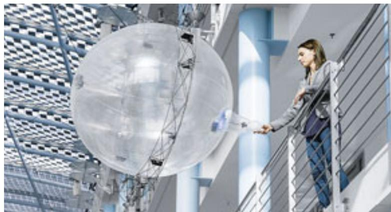
Drohnenforschung «leichter als Luft». Heliumkugel mit integrierten Greifern.
