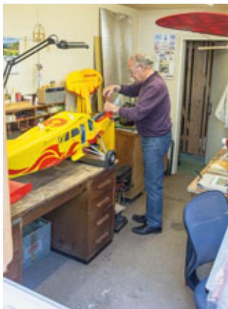
Für den bevorstehenden Flug wird vom Statik- auf den Flugpropeller umgerüstet. Durch die hinten im Raum sichtbare offene Türe passen Menschen, aber keine der grossen Flugzeuge.
