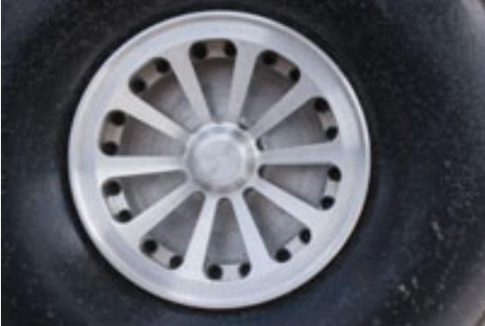
Felge gedreht, gefräst und gebohrt, dann mit kleinsten Imbusschrauben montiert.
