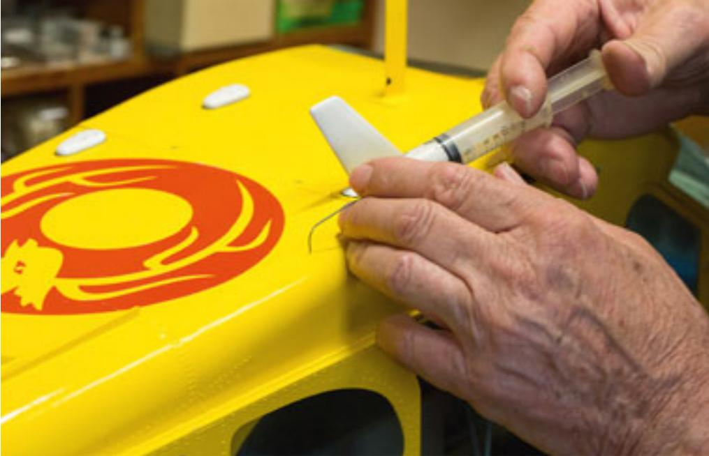
Ungefähr 25000 Nieten sind am Flugzeug nachgebildet. 6 mm Durchmesser am Original, ca. 1 mm hier am Modell. Mit der Spritze und feinen Leimtropfen eine Fleissarbeit mit kaum absehbarem Ende.
