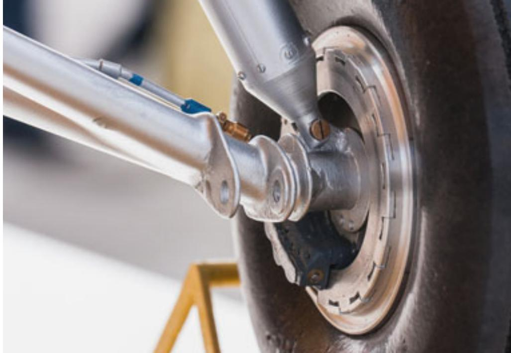
Radaufhängung aus geschweisstem Metall mit Bremsleitungen und beschrifteten Bremszangen.
