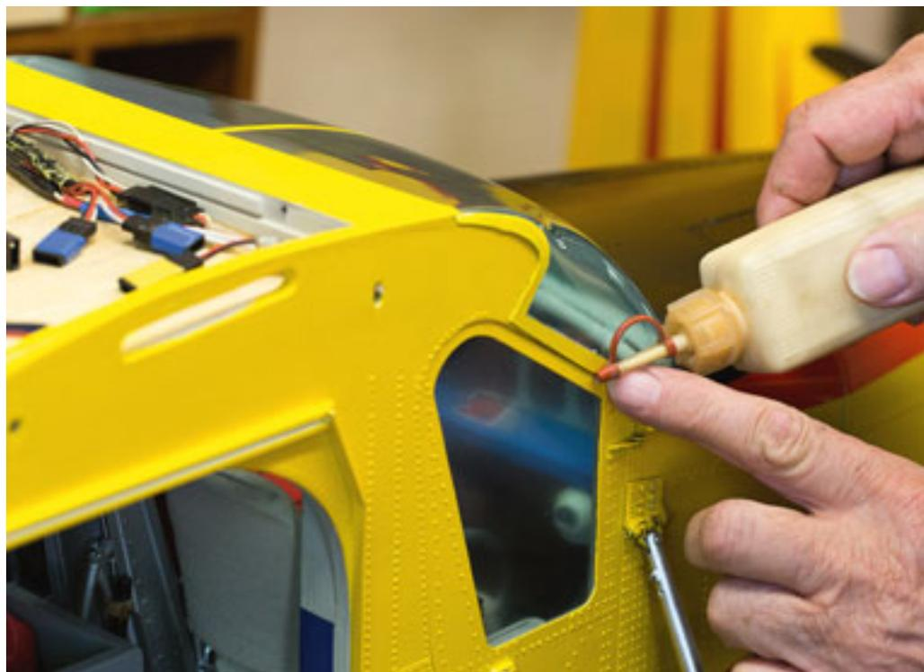
Frontscheibe schwimmend aufgehängt. Nach einem Spannungsriss ist das «Kunststoffglas» nur noch an der linken und rechten seitlichen Cockpitstrebe fest geleimt. Im Nachhinein festgestellt. Auch beim Original sei dieser Riss nach einer etwas unsanften Landung so aufgetreten.
