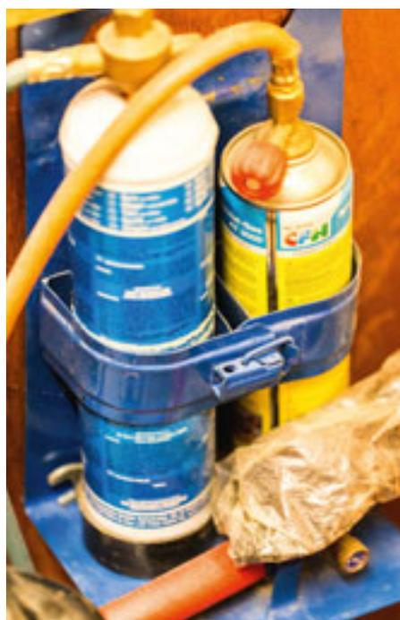
**Schweissanlage «en miniature» – voll funktionsfähig auf kleinstem Raum. Poste de soudure en miniature malgré tout opérationnel dans ce si petit espace.**
