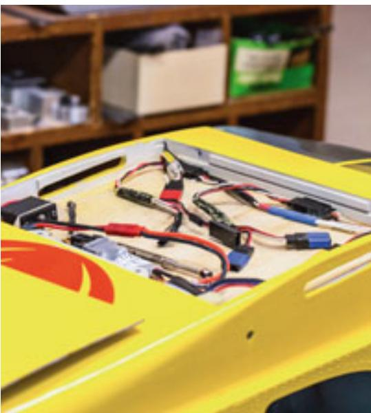
**Sicherheit:** Die Beleuchtung wird durch den komplett autonomen Akku versorgt und von der übrigen Bordelektronik getrennt untergebracht. So werden halt auch die kleinen Konstruktionsschwächen originalgetreu nachvollzogen.
