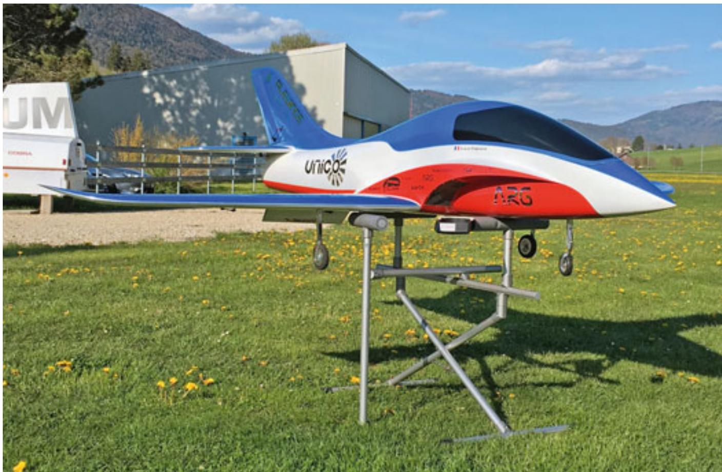
Support modulaire stable en tubes d'aluminium.
