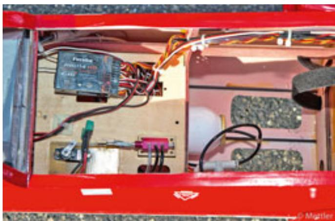
Die Luft gelangt aus dem weissen Tank in der Mitte zum mechanisch angesteuerten Ventil, welches direkt die Druckzylinder an den Fahrwerken ansteuert.
