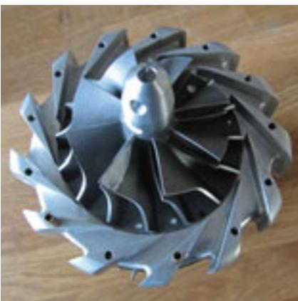
Die ersten Teile nehmen Gestalt an: Verdichterleitsystem und Wellentunnel. Das Verdichterrad ist zugekauft aus dem Bedarf für Turbolader.
