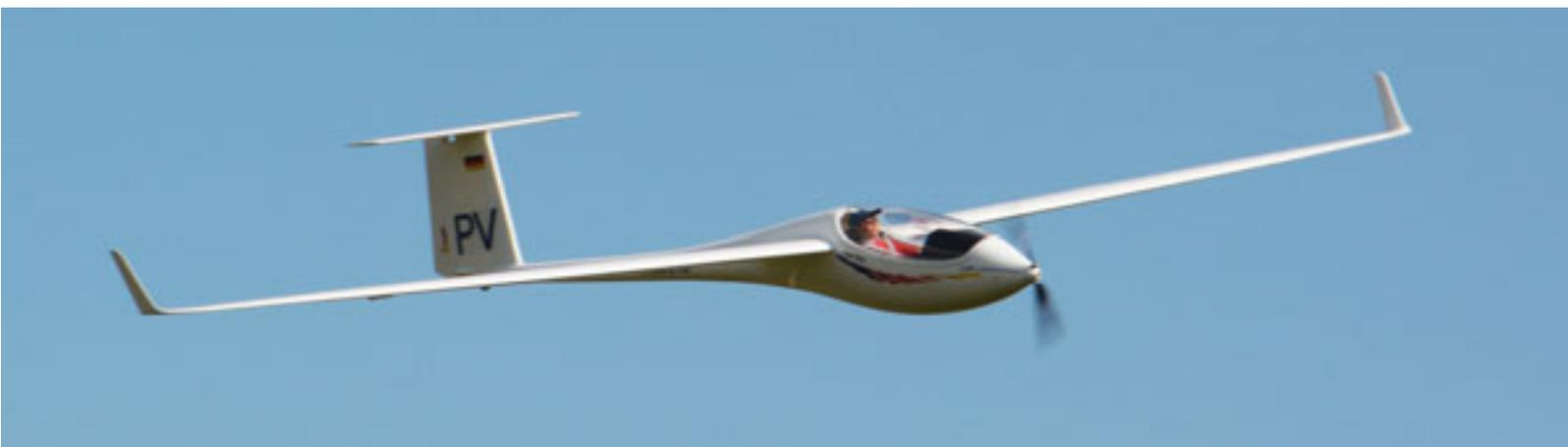
Vorbeiflug mit im Teillastbereich laufenden Motor, mit Vollgas gehts im 30-Grad-Winkel nach oben. Kein Wunder, bei dem auf Weight-Watchers-Niveau liegenden Fluggewicht.
