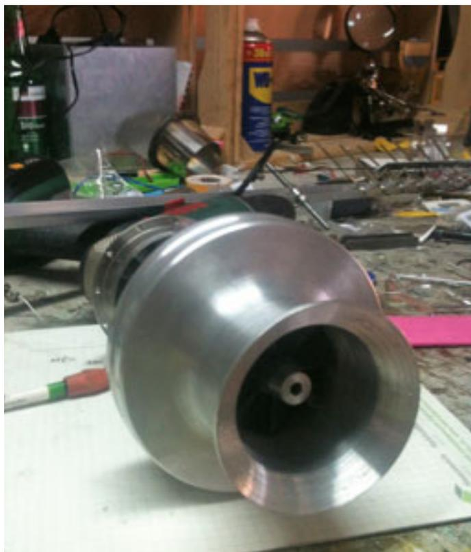
Der Lufteinlass wurde aus dem Vollen gedreht. Dazu wurden Koordinaten in einem Raster von einem Zehntelmillimeter angefahren.
