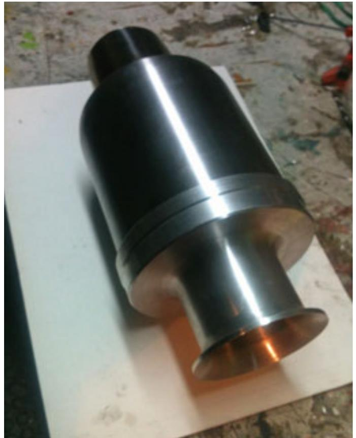
Langsam nimmt das Werk Gestalt an. Es fehlen aber noch alle Anbauteile wie Starter, Sensoren und die Glühkerzenaufnahme.
