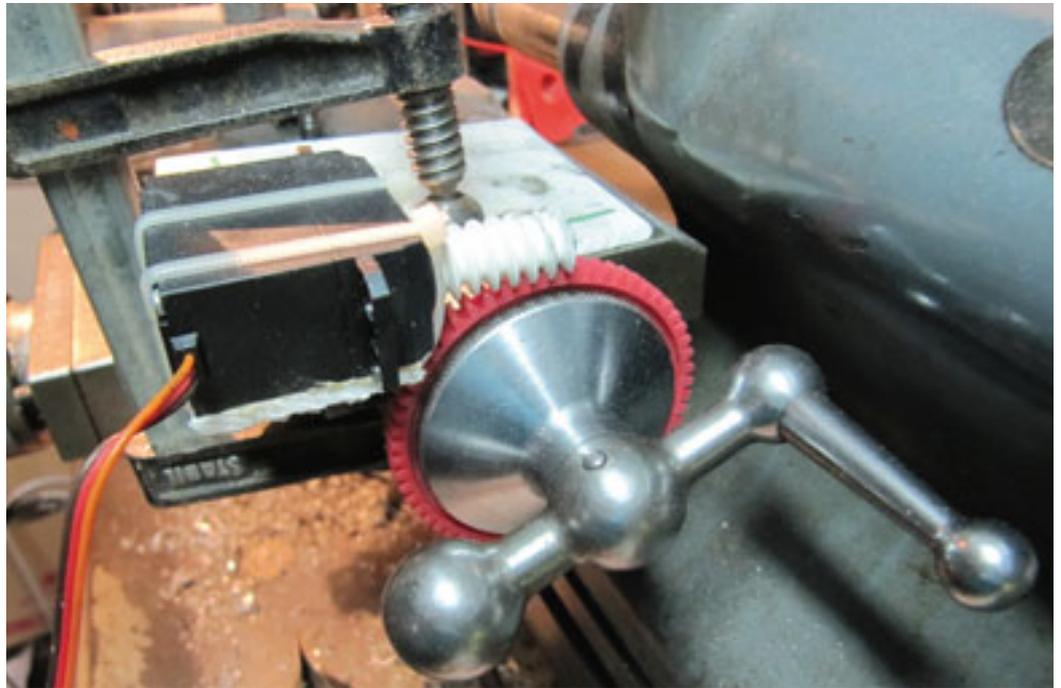
Ein umgebauter Servo treibt das Handrad meiner Schäublin-Drehbank an. Der so improvisierte Längsvorschub übernahm einige Stunden Arbeit beim Schleifen der Welle. Profis dürfen gerne über mich lachen.
