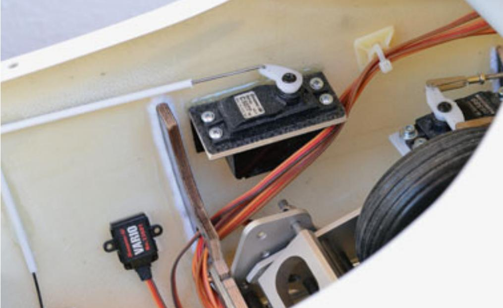
**Das SK-Servo bedient die Kupplung in der Schnauze über einen 1,2-mm-Stahldraht. Le servo du crochet actionnant le crochet de remorquage par un fil d'acier de 1,2 mm.**
