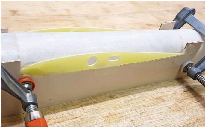
**Bau der Rumpf-Flügel-Anformung mit Hilfe von Schablonen.**
