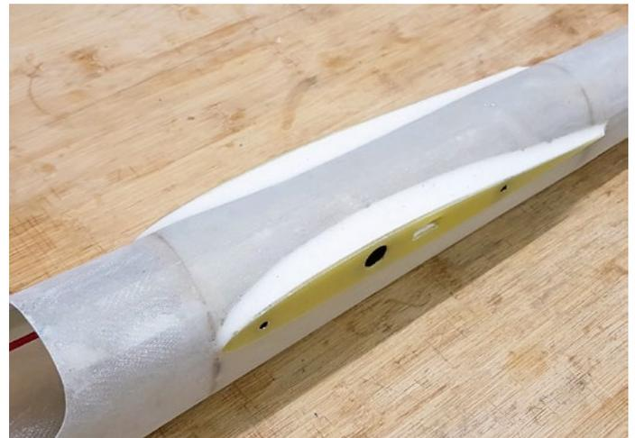
**Anformen der Anschlussrippe an den Rumpf mit Hilfe von Spachtelmasse.**
