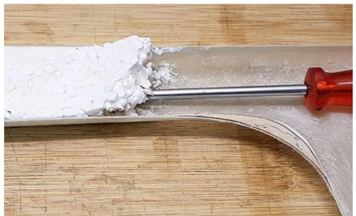
Entfernen des Styropors aus der Halbschale.
