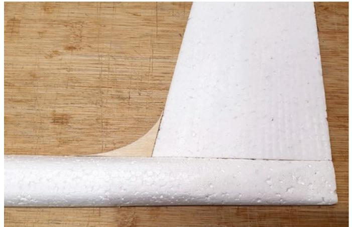
Fertig angeformte Seitenleitwerksflosse.
