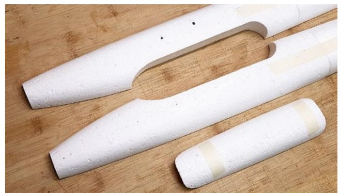
Zusammengefügte Rumpfsegmente mit ausgeschnittener Kabinenhaube.
