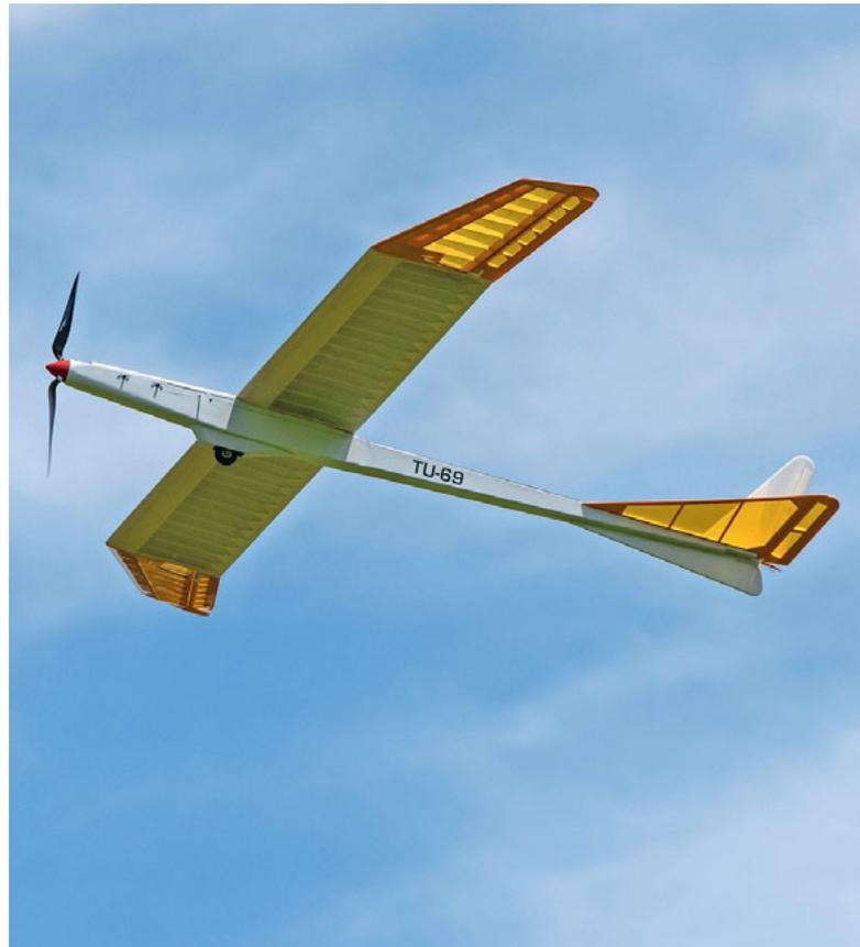
Mit 26 dm<sup>2</sup> monokristallinen Solarzellen bestückt der Sonne entgegen.
