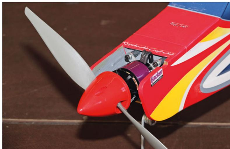
Esempio di trasformazione: motori a scoppio – elettrico.
