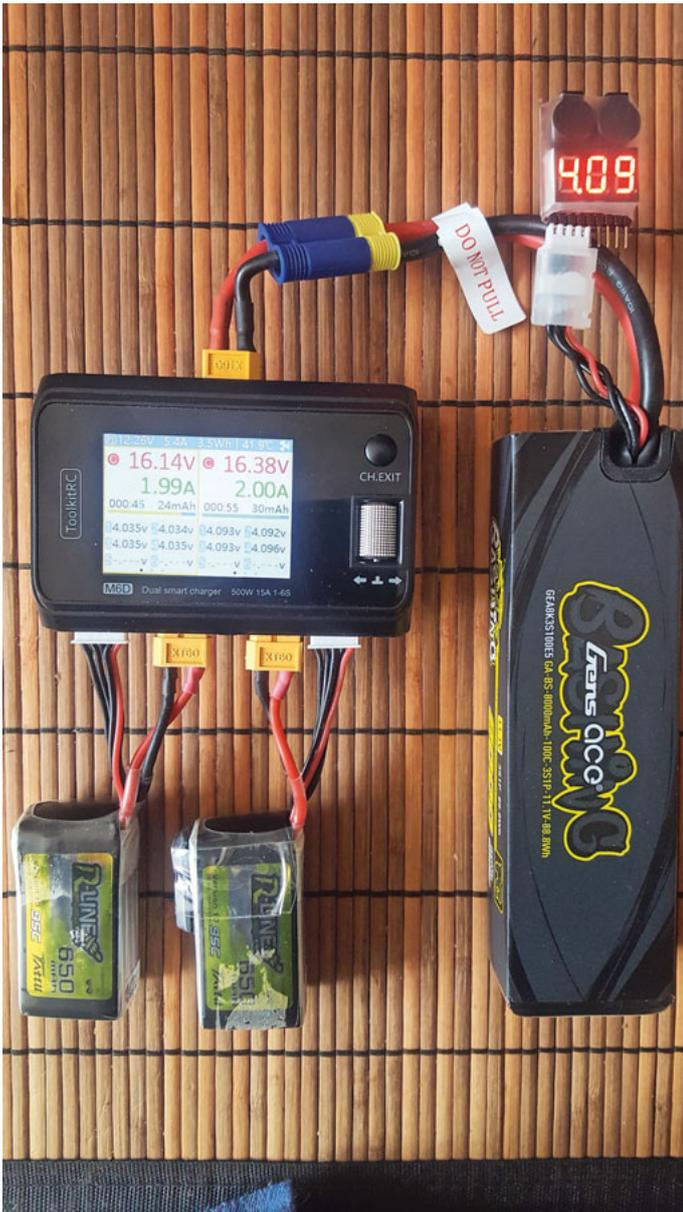
Ensemble de charge: un accu LiPo 8 Ah avec le buzzer connecté sur la prise d'équilibrage, le chargeur Toolkit 6D, 2 accus en charge.
