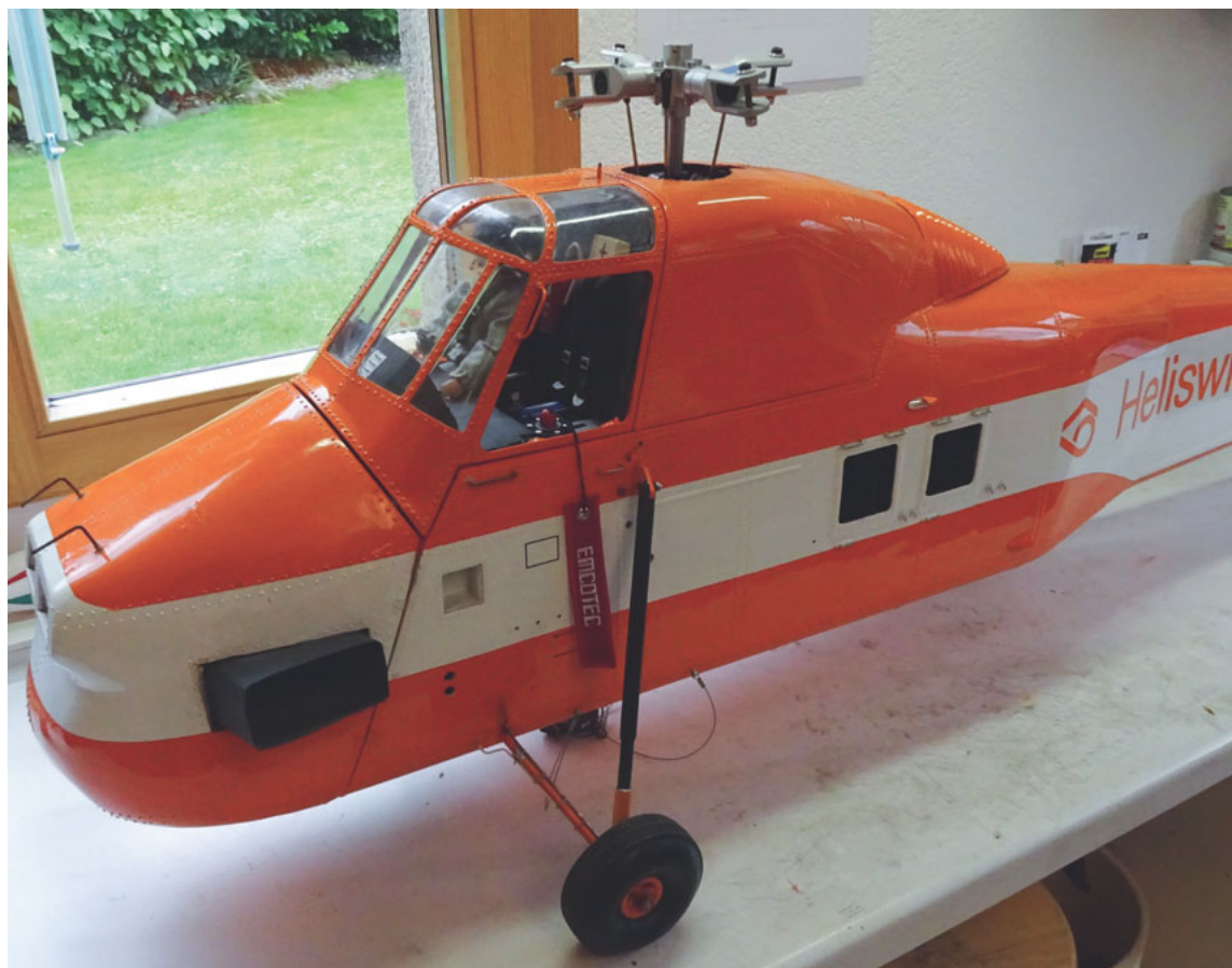
Das Modell nach dem erfolgreichen Umbau auf Elektro beim abschliessenden Arbeiten auf der Werkbank. Schön zu sehen der neue Alu-4-Blattkopf von SD. Zu sagen gibt es hier, dass der 4-Blatt-Hauptrotorsatz von 1992 wieder gebraucht werden konnte, ebenfalls auch die Heckblätter.
