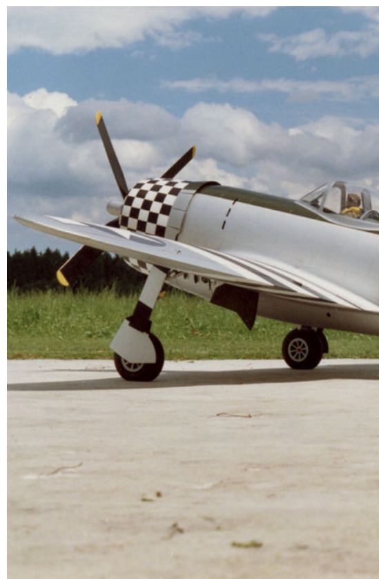
Die Republic P-47 D «Thunderbolt». Ein klassischer Warbird mit ca. 240 cm Spannweite, angetrieben durch einen ZG 62 ccm bei ca. 12 kg Abfluggewicht.
