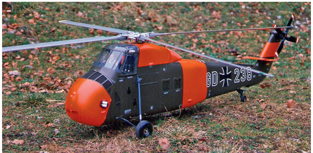
Das Modell von Rolf Oertli in der ursprünglichen Ausführung von 1993, mit SSM-Mechanik und ZG-22 Benzinmotor, in der Lackierung der Bundeswehr.
