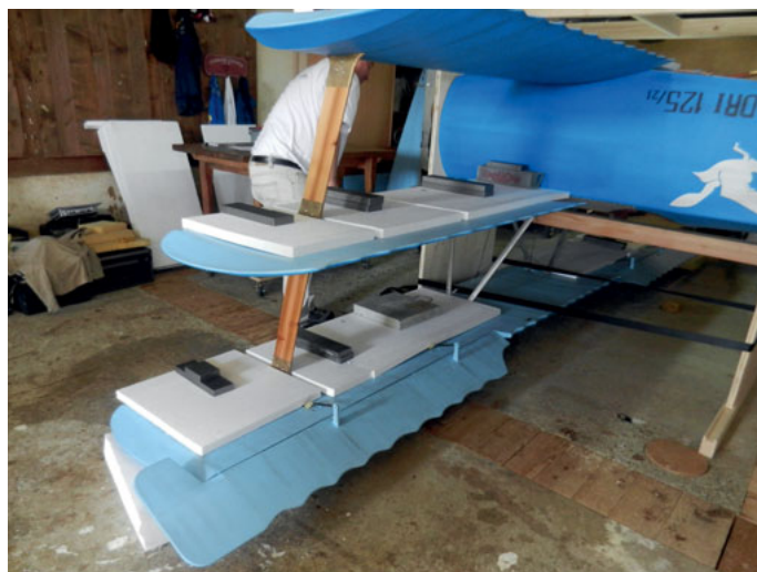
Test de charge des ailes d'un Fokker triplan pour homologation. Les masses sont progressivement ajoutées pour mesurer le comportement des ailes.
