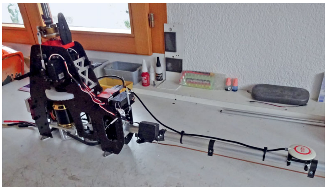
Die komplette Elektromechanik vor dem Einbau in den Rumpf.
