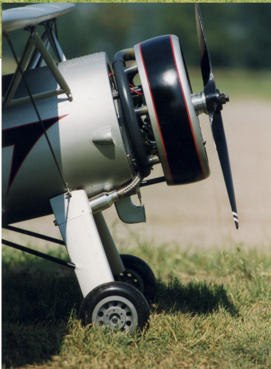
Die Waco UPF-7 des Kunstfliegers und Airshow-Piloten Jimmy Franklin. Modell mit ca. 190 cm Spannweite, Antrieb OS Boxer 4 Takt 50 ccm. Entstanden Mitte der 80er-Jahre.
