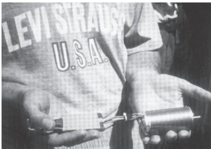
Aveox-Brushless-Motor, wie er vom US-Team erfolgreich eingesetzt wurde (2. Rang hinter Österreich). Leider sind auch auf diesem Bild die Sensorkabel nicht sichtbar.
