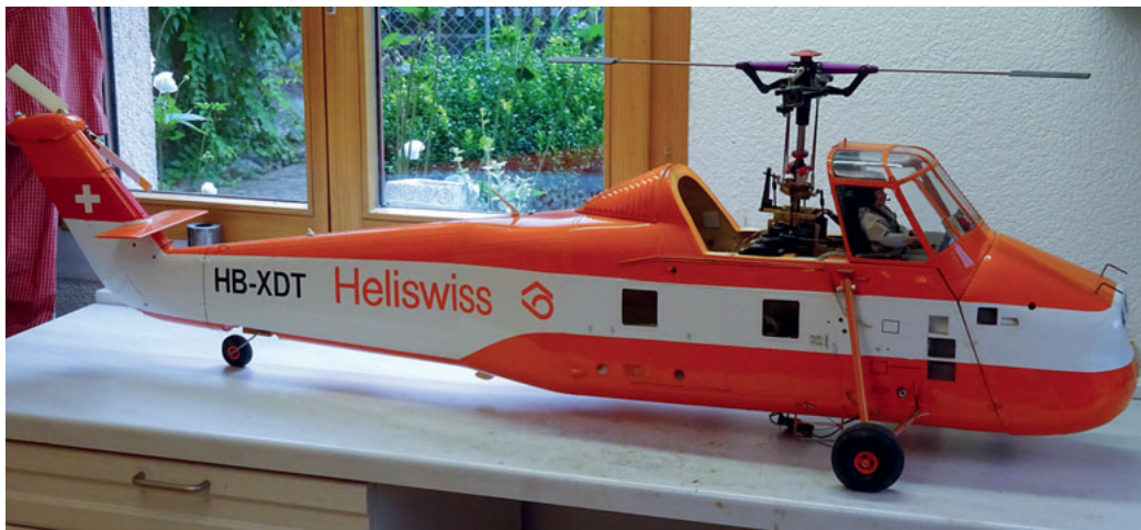
Nach dem Umbau auf die Huner-Mechanik mit Webra-Motor und der Umlackierung in die Farben von Heliswiss. Leider nur mit 2-Blatt-Paddelkopf und 2-Blatt-Heckrotor fliegbar.
