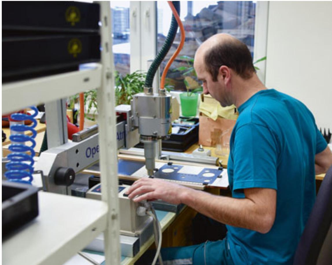
Die Senderabdeckung wird für das Bedrucken gereinigt.
