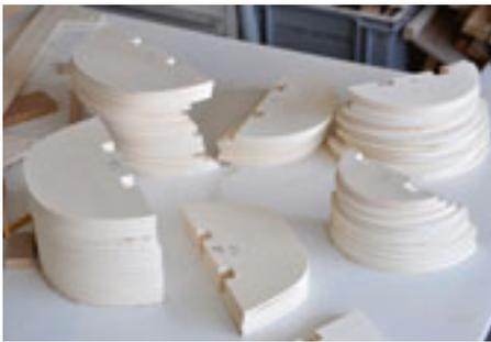
**Holzspanten für das Kabinenhaubenmodell.**
