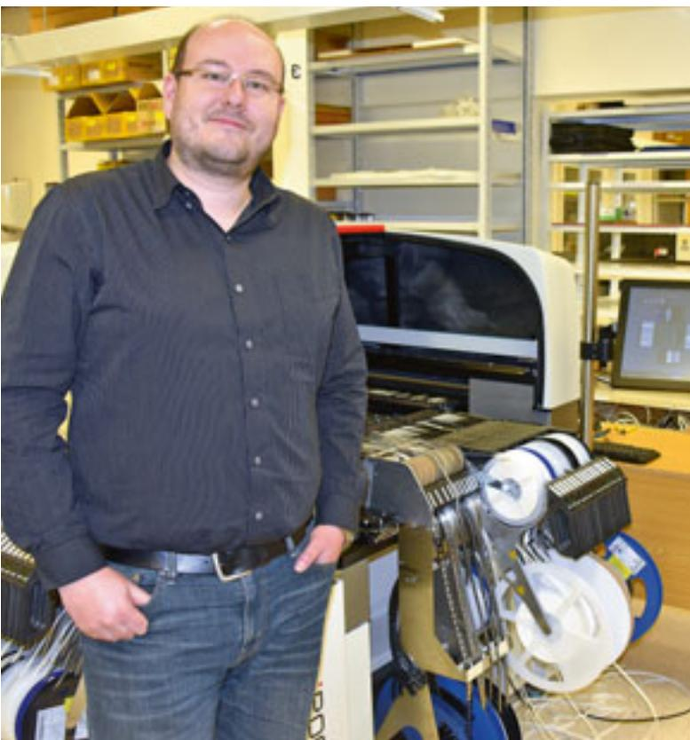
Derselbe Bestückungsautomat. Hier ist das Magazin mit den verschiedenen Bauteilen auf Rollen zu sehen. Der Revolverkopf holt sich dort die Bauteile ab, die er dann an den programmierten Positionen auf die Leiterplatte absetzt. Der Revolver dient als Zwischenspeicher und muss deshalb die Verfahrenswege vom Magazin zur Leiterplatte optimieren. Die Leiterplatte ist immer ein Nutzen mit mehreren Einzelnen damit das Ausrüsten optimiert wird.
