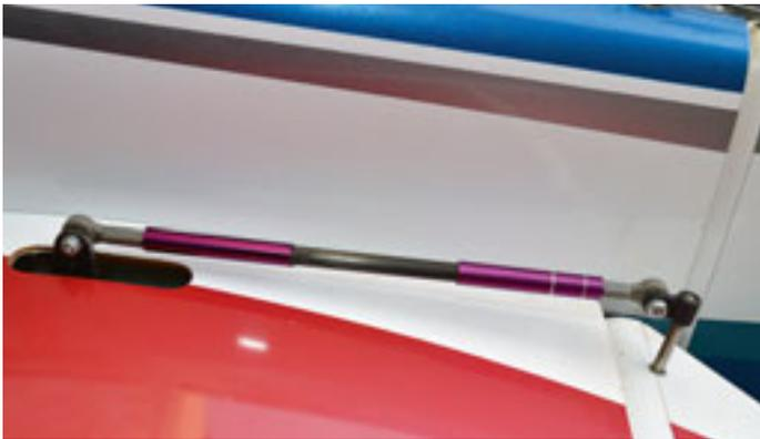
**...und heute. Pro Höhenruder-Blatt ein eigenes 15-mm-Servo, kugelgelagerte Anlenkung, Schubstangen aus Kohle.**
