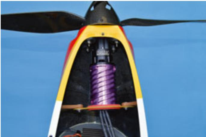
**Motoreinbau, auf Schwinggummis aufgehängt, Seitenzug voll einstellbar. Hier sind die im Text erwähnten drei Grad gut zu erkennen.**
