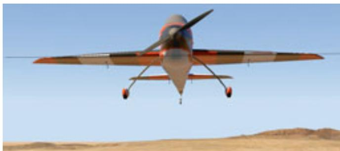
**Genauso wichtig: Auswiegen um die Längsachse, das Modell muss die Waage halten.**
