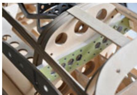
**Hauptspant mit Holmkasten.**
