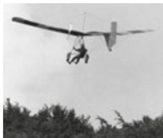
**Ernst Friedel mit einem UL, das von amerikanischen Autozubehörmotoren (Sitzverstellung) angetrieben wurde. Der Strom kam aus zwei dicken, über den Rädern angebrachten NiCd-Batterien.**
