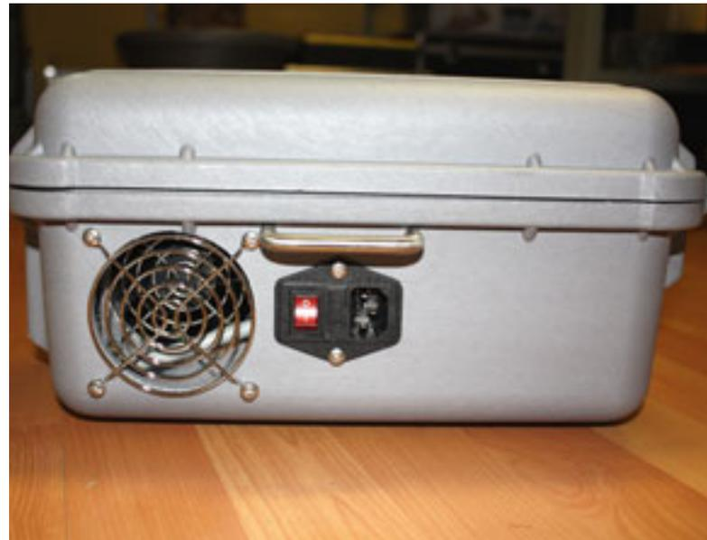
240-V-Steckdose mit Feinsicherung und Lüftungsgitter.
