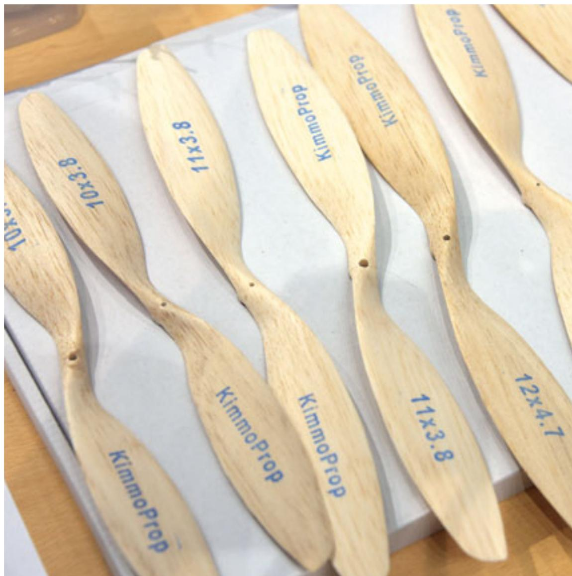
Aus dem guten Holz «geschnitzt»: Balsa-Props aus einem Balsablock.
