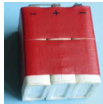
**Der Rulag-Akku war bei Modellbauern sehr beliebt. Sie bauten sogar eine Abschaltautomatik dafür. Ein Bleiakku im Weichgehäuse, ursprünglich gemacht für militärische Anwendungen (hier auch Excel-Zeichnung der Abschaltautomatik).**
