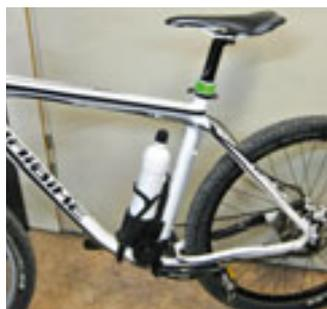
**Zu einem Pedelec umgebautes Mountain-Bike. Der Antrieb besteht aus Elektroflug-Komponenten. Der Akku (6s/6,6 Ah-LiPo) versteckt sich – ja wo denn?**
