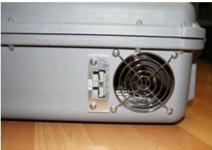
24/48-V-Steckdose in der Ausführung SB50 Bulk, inkl. Alurahmen für besseren Halt während des Steckens.
