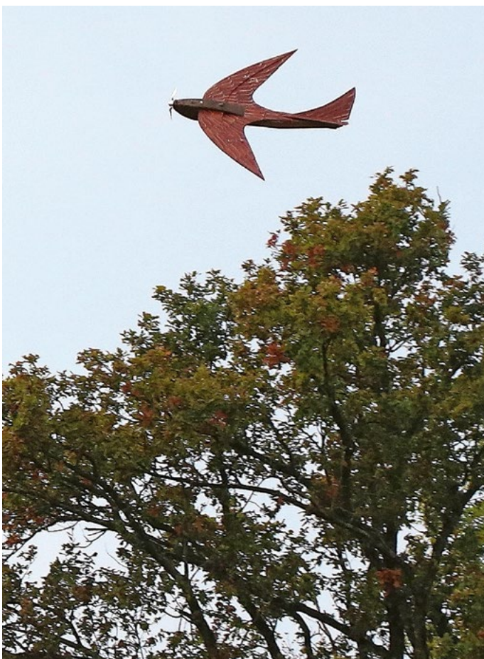
Die mit dem nicht gerade sehr widerstandsarmen KfM4-Profil versehene Tragfläche ermöglicht dem Modell im Horizontalflug immerhin flotte 130 km/h.
