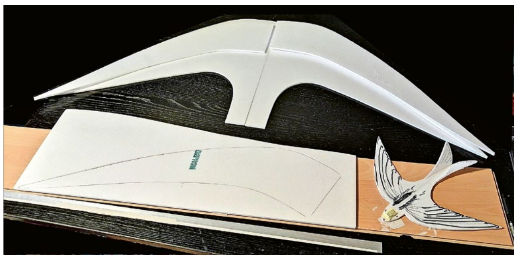
Bevor die KfM4-Flächenteile zusammengeklebt werden, müssen sie für hohe Stabilität mit Kohlefaserstäben, eventuell noch mit einer Lage Glasfasergewebe verstärkt werden. Noch sichtbar: das so wichtige Mini-Modell.
