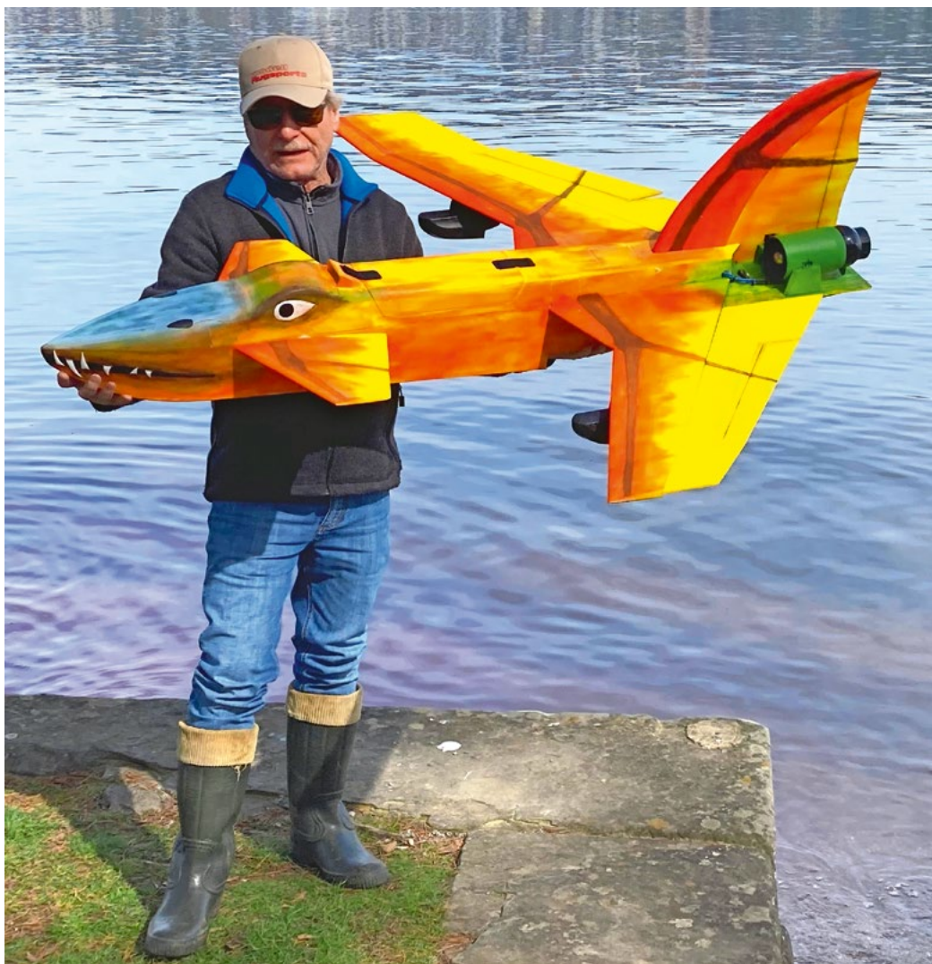
René Signers absolut einmaliger Wasserflugdrache verdient es, noch aus einer anderen Perspektive gezeigt zu werden. Angetrieben wird dieses mit KfM4-Tragflächenprofil ausgestattete Depronmodell von zwei 70-mm-FMS-Impellern mit 360-Grad-Vektorsteuerung. Ein komplexes Modell, in dem sehr viel Erfahrung steckt.
