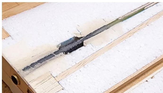
noch mit einem CFK-Rowing umwickelt wird.
