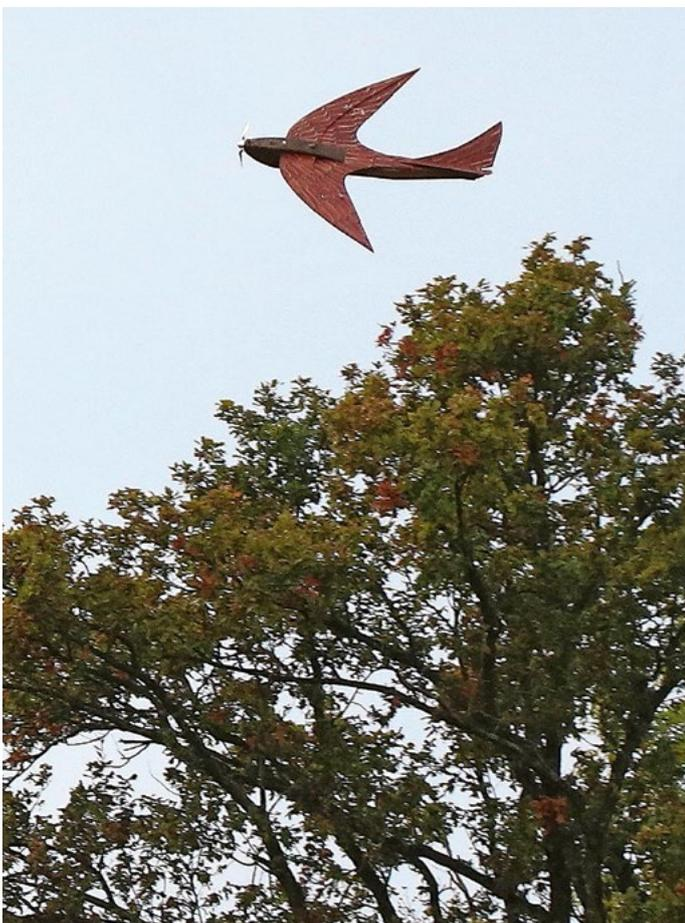
Die mit dem nicht gerade sehr widerstandssarmen KfM4-Profil versehene Tragfläche ermöglicht dem Modell im Horizontalflug immerhin flotte 130 km/h.
