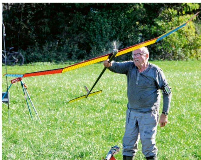
sen nicht möglich. Um die Modelle optimal einzustellen, ist ein entsprechendes Training unumgänglich. Die Modelle werden vorwiegend aus Kohle gebaut. Ohne diesen Werkstoff ist es nicht möglich, die Kräfte, die beim Start entstehen, zu überstehen. Es ist deshalb äusserst aufwendig, solche Modelle zu bauen.
