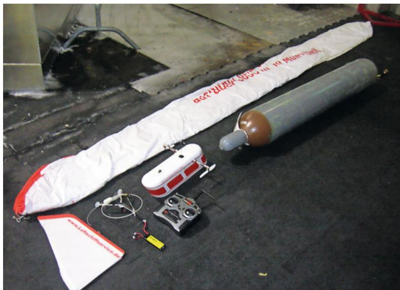
Das Airship wird mit einem 2S-LiPo à 1900 mAh betrieben. Für den Vorwärtsschub und die vertikale Lagekontrolle dienen zwei seitlich an der Kabine angebrachte, schwenkbare Motoren sowie ein Heckmotor als «Seitenruder». Im Grunde lässt
