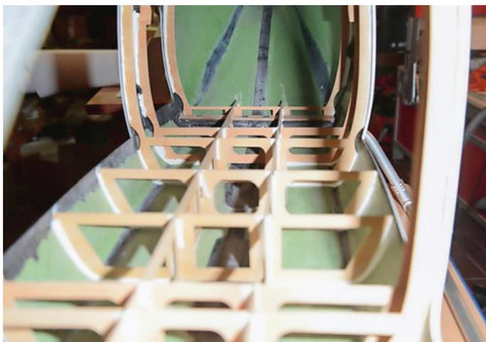
Fertig eingeharzten Spantensatz. Sehr schön hier zu sehen die im Rumpf eingearbeiteten Kohlefaser-Rohwings.
