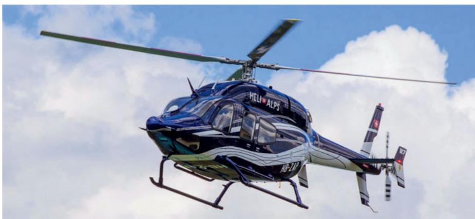
**Bell 429 von Anton Laube, 2,5 Meter Rotordurchmesser, 2,85 Meter lang und 31,5 Kilogramm schwer.**
