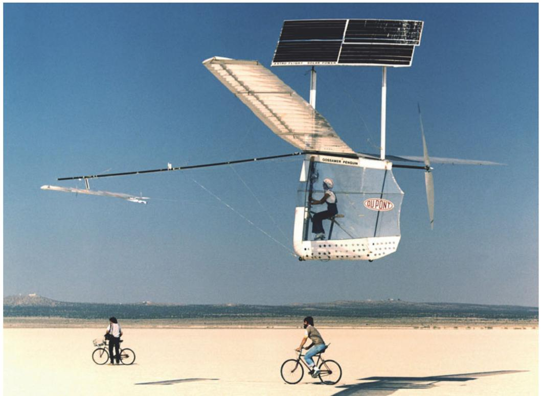
Das erste manntragende Solarflugzeug «Gossamer Penguin» war mit einem AstroFlight Cobalt 40 Motor ausgerüstet.
