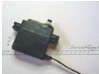
Abbildung 1: Einbauproblematik Mikro servo.
