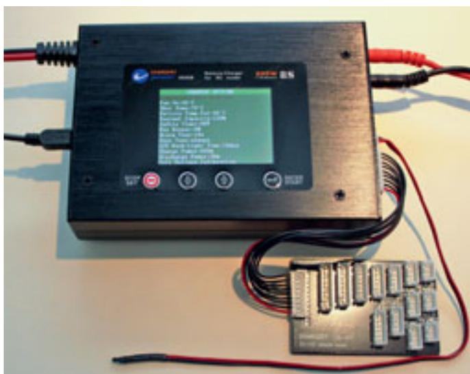
**Chargery 5008B kann bis zu 8 LiPos «am Stück» mit 500W und max. 20 A laden. Ein vielseitiges Gerät für Zeitgenossen, die sich gerne mit Technik befassen.**
