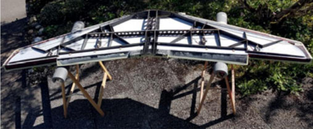
Flügelhälfte des Hawk in der Form mit den «Eingeweiden». Schalensandwich aus 67 g/m<sup>2</sup> Kohle, 2 mm Rohazell, 50 g/m<sup>2</sup> Glas.
