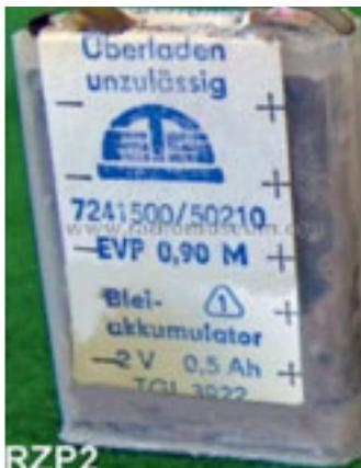
**Gasdichter Trocken-Akku (Blei mit Säure-Gel); 2 V/0,5 Ah für Kleingeräte und Experimente; 50 mA Nenn-Entladestrom. Erste Herstellung bereits 1936 in Zelluloid-Gehäuse.**
