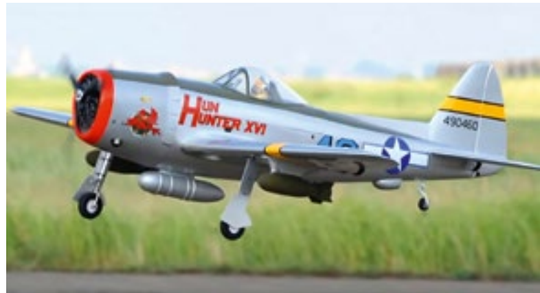
Phoenix P-47 Thunderbolt, das amerikanische Jagdflugzeug aus dem 2. Weltkrieg, mit einer Spannweite von 200 cm und einem Fluggewicht von 8–10 kg.
