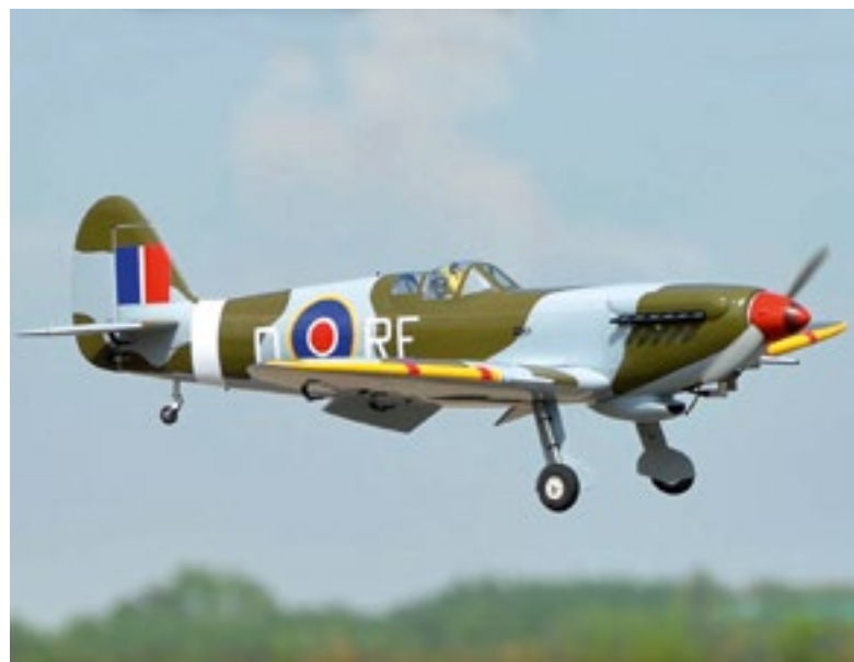
Phoenix Spitfire Mk 2 , das englische Jagdflugzeug aus dem 2. Weltkrieg, mit einer Spannweite von 180 cm und einem Fluggewicht von 5,8–6,2 kg.
