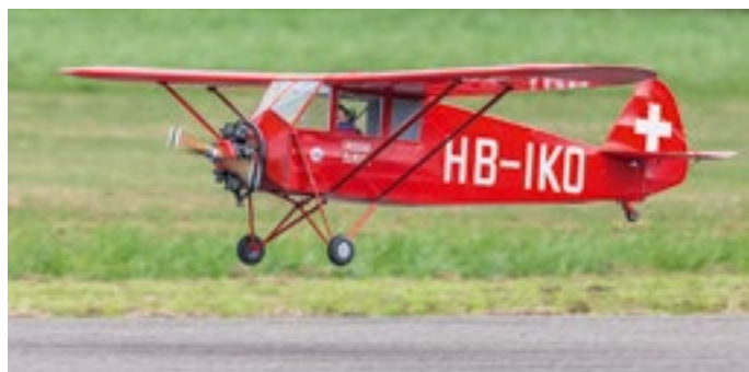
Comte AC-4 Gentleman mit 3,05 m Spannweite und 7-Zylinder-Sternmotor in Swissair-Bemalung von Karl Petz.
